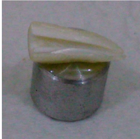
Figura 9- Amostra fixada no stub de alumínio com cianoacrilato.
