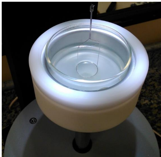
Figura 7- Anel de platina submerso na solução depositada no frasco de vidro do tensiômetro.
