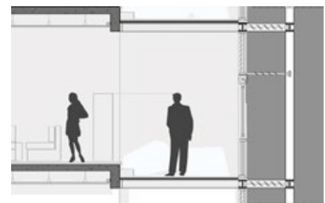
Unidades habitacionais: detalhe da estrutura metálica anexada ao corpo da edificação original.
