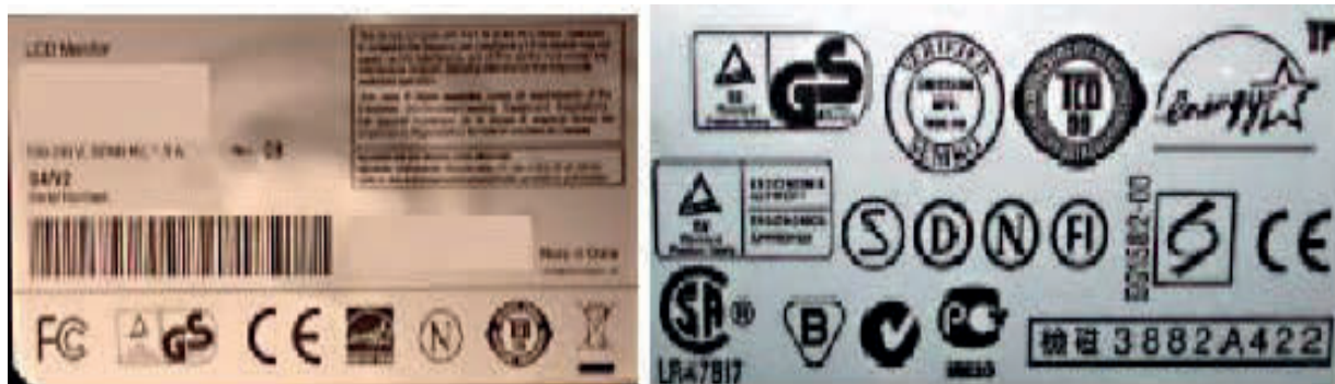
Figura 25 – Placas de identificação de monitores
