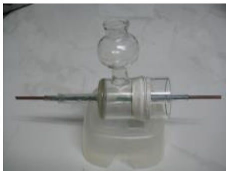
Figura 4.3. Célula de referência utilizada para determinar os valores de condutividade elétrica de diferentes soluções salinas.
