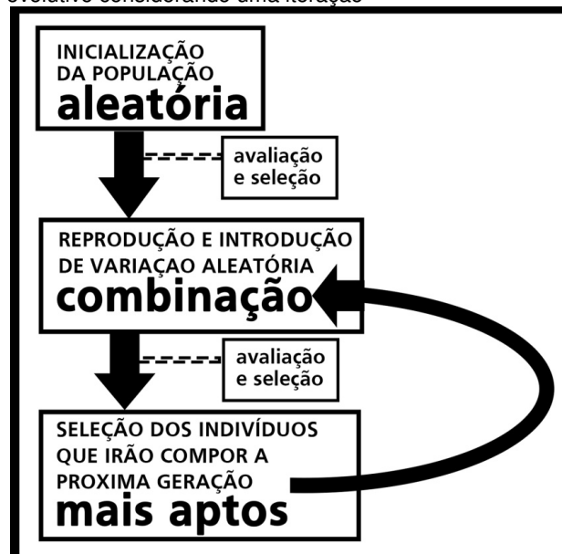
Figura 27 - Estrutura típica de um algoritmo evolutivo considerando uma iteração
