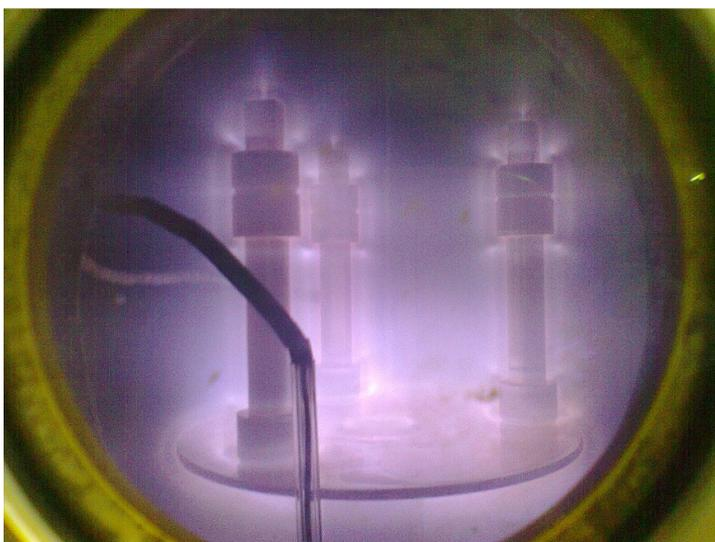
Figura 14 - Disposição dos pinos no interior da câmara de nitretação.
