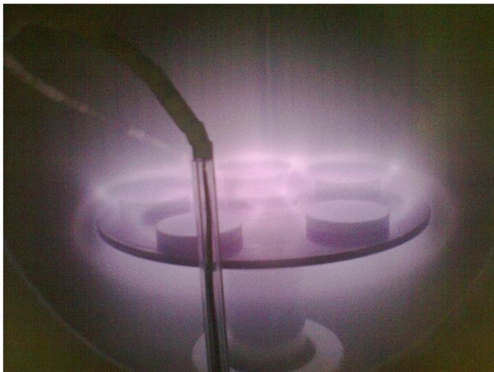
Figura 13 - Disposição das amostras no interior da câmara de nitretação.
