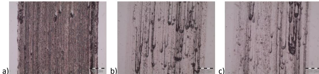
Figura 70 - Trilhas de desgaste. Da esquerda para direita: (a) amostra não nitretada, (b) amostra nitretada com 2,5h e (c) amostra nitretada com 5h.
