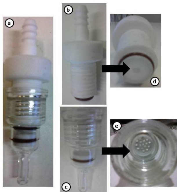
Figura 23. (a) Biorreator de perfusão desenvolvido para o cultivo das células-tronco. (b) Parte superior de teflon, (c) parte inferior de vidro, (d) passagem confeccionada para o escoamento do fluido de trabalho e (e) suporte de teflon onde os scaffolds semeados foram colocados.
