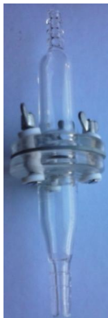
Figura 22. Modelo para o biorreator de perfusão com parafusos (baseado em Jaasmaet al. , 2008).
