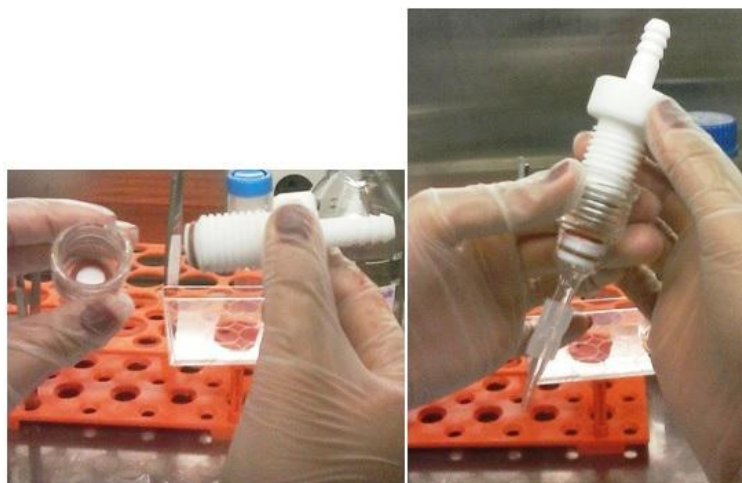
Figura 19. Montagem dos scaffolds em sanduíche dentro do biorreator.
