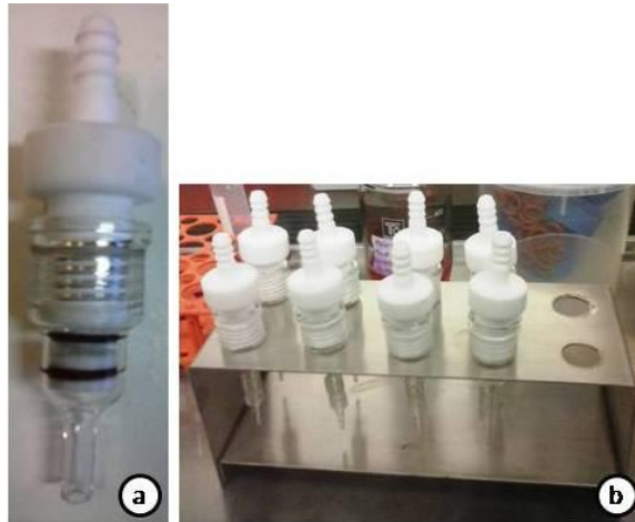
Figura 15. (a) Biorreator de perfusão e (b) estante utilizada para sustentação dos biorreatores durante o experimento.
