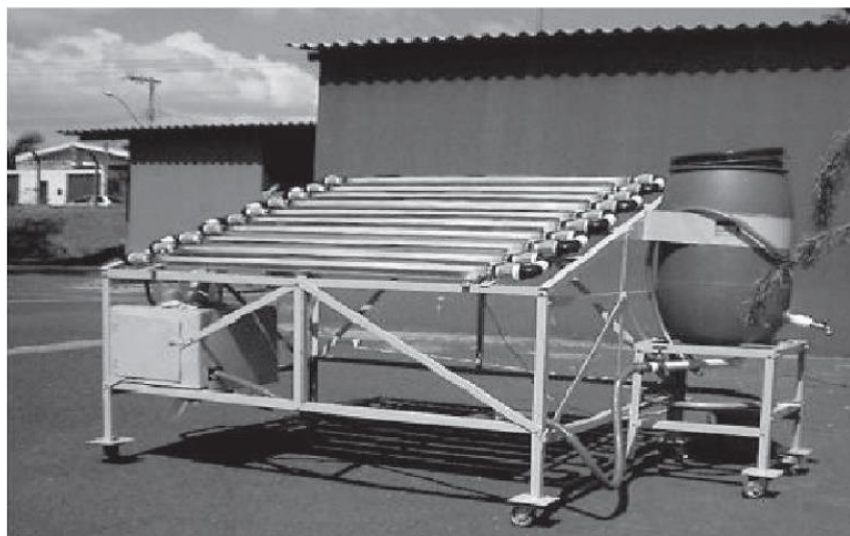
Figura 1. 3: Reator fotoquímico solar do tipo CPC proposto por Duarte et al. (2005).
