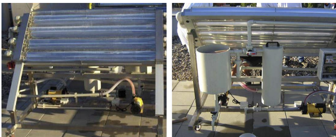
Figura 1. 4: Planta piloto de um reator solar do tipo CPC proposta por Pereira et al. (2011).
