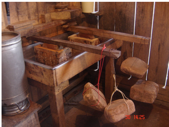
Foto 8 – Produção de QS do dia sendo prensada
