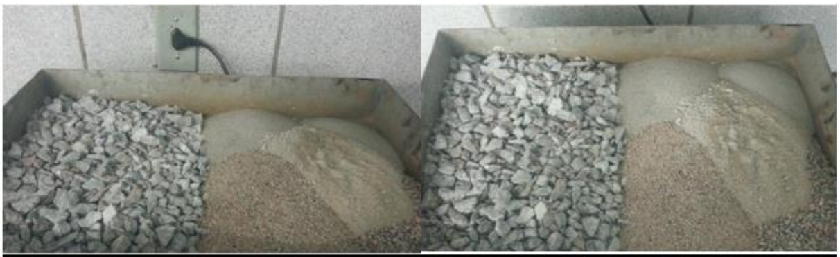
Figura 14: Preparação das bandejas para a Moldagem Marshall, com as diversas frações de materiais e cal
