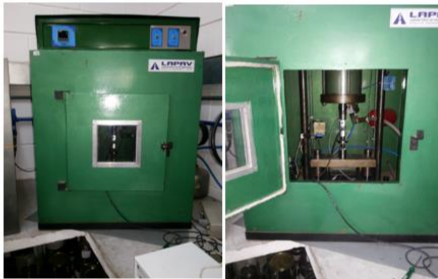
Figura 22: Equipamento utilizado pelo LAPAV/UFRGS para realização do ensaio de fadiga por compressão diametral
