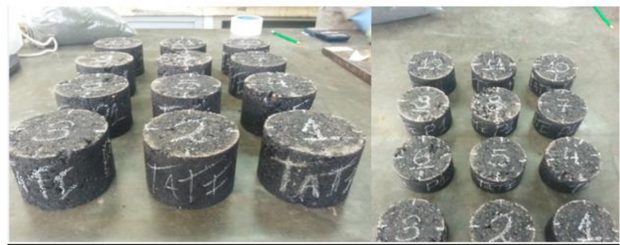
Figura 15: Corpos de Prova moldados pelo Método Marshall
