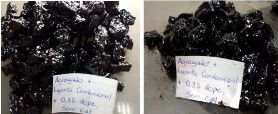
Figura 32: Antes e depois da amostra ensaiada com ligante convencional+0,3% de DOPE
