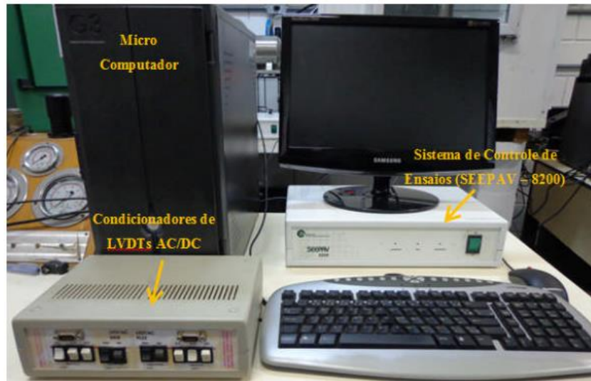
Figura 23: sistema de aquisição e controle de dados do equipamento de ensaio de fadiga por compressão diametral (Colpo, 2014).
