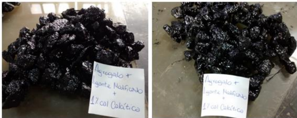
Figura 30: Antes e depois da amostra ensaiada com ligante modificado +1% de cal calcítica
