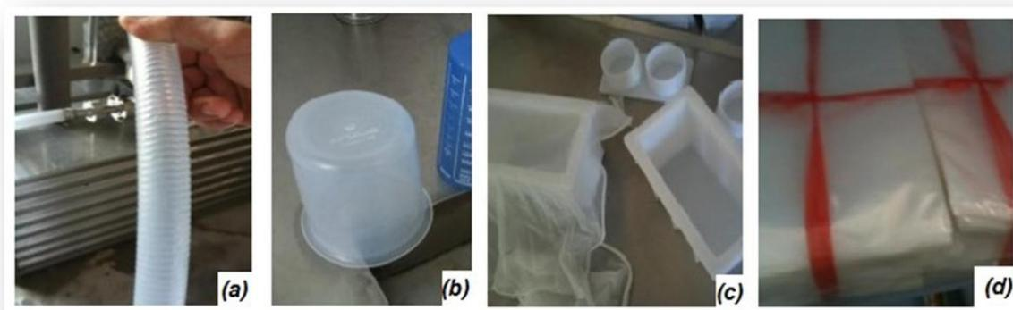
**FIGURA 5:** Materiais e Utensílios utilizados na produção do queijo colonial (a) mangueira (PVC espiral), (b) Becker (polipropileno), (c) forma do queijo (polipropileno), (d) embalagem (nylon/polietileno).
