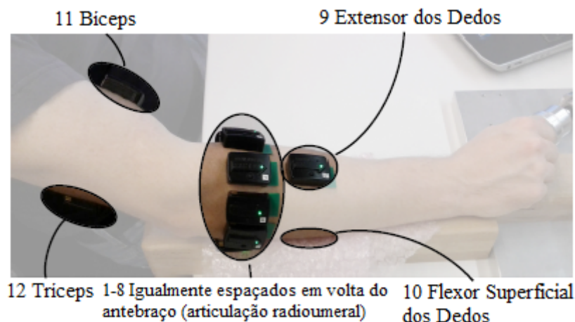
Figura 3.1: Posicionamento dos doze eletrodos superficiais no braço. O eletrodo do músculo flexor superficial dos dedos está oculto pelo braço e, portanto, não é visível na imagem (adaptado de GIJSBERTS et al. , 2014).
