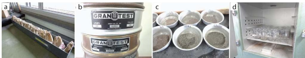
Figura 7 – a) Amostras de calha recebidas; b) peneiras utilizadas para separação granulométrica; c) Lavagem das amostras d) Armazenamento na estufa para secagem.
