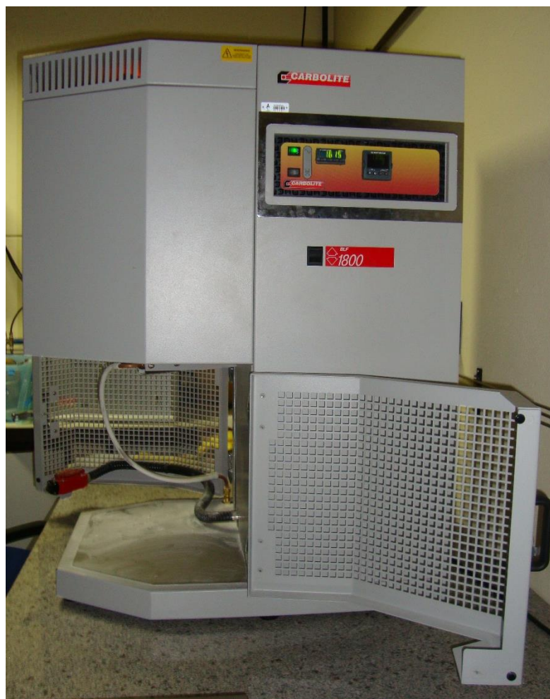
Figura 10. Forno Carbolite® BFL 18/3, LAPMA. A entrada da amostra se dá através de um elevador na porção inferior da cabeça do forno. Isso minimiza a perda de calor do forno durante o manuseio da amostra.
