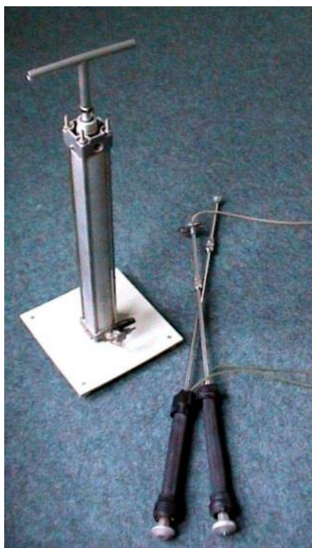
Figura 11 - Sonda acoplada do aparelho Sarad para análise de radônio em solos.
