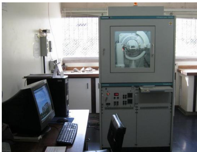
Figura 14 - Difratorômetro de Raios X SIEMENS BRUKER AXS, modelo D5000 do Laboratório de Difração de Raios X do Instituto de Geociências da UFRGS.
