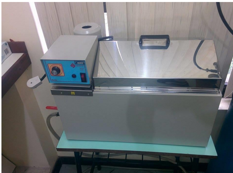
Figura 8 - Equipamento de banho térmico da marca Quimis, modelo Q-251, utilizado para o banho térmico.
