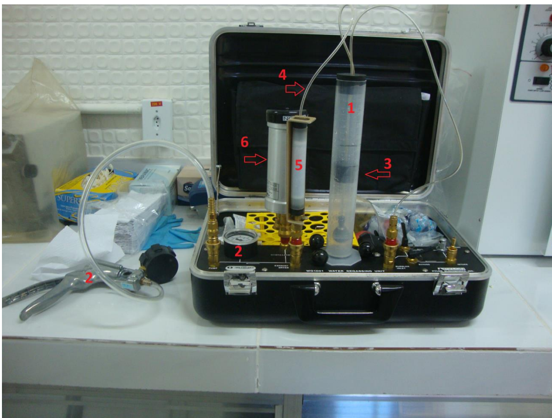
Figura 16- Equipamentos Pylon. 1- tubo de água; 2- bomba de vácuo; 3- agitador; 4- mangueira; 5- tubo desumidificador; 6-Célula de Lucas.
