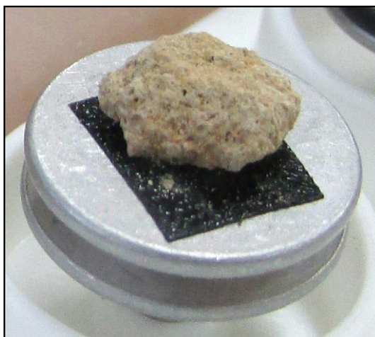
Figura 14. Exemplo de amostra preparada para o imageamento no MEV, medindo menos de 1 cm.
