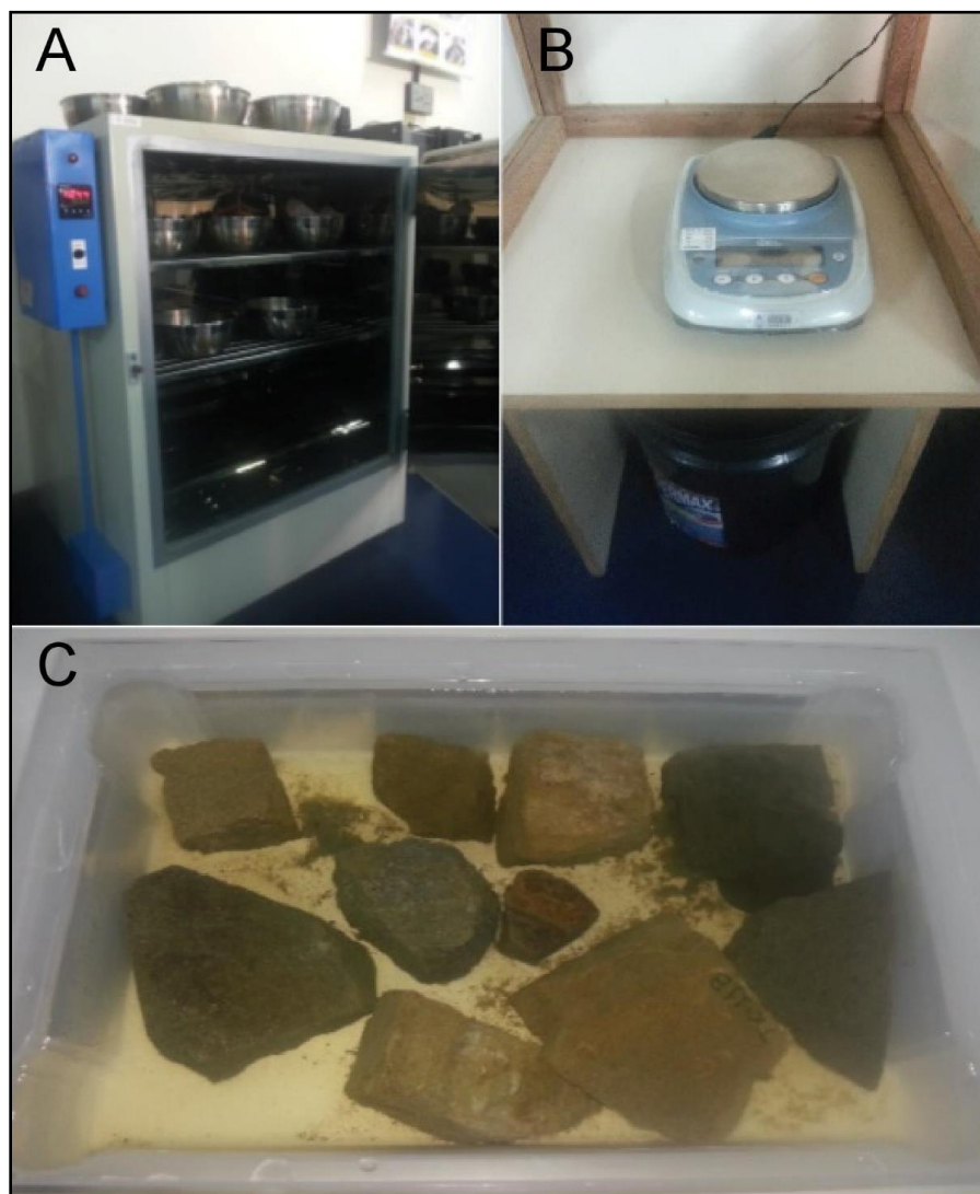
Figura 7. Fotos dos equipamentos utilizados nas diferentes etapas de obtenção da porosidade aparente. A) Estufa para secagem das amostras. B) Balança para pesagem das amostras, após a secagem e a saturação. C) Amostras imersas na água para a saturação.
