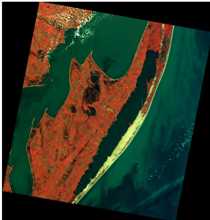
Figura 4. Exemplo de Imagem orbital capturada pelo satélite CBERS 2 em composição RBG-423 (canal do infravermelho).
