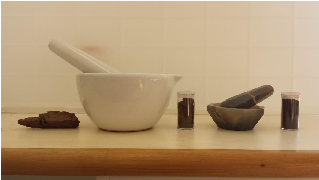
Figura III. 1 Caminho percorrido desde a amostra bruta até a mesma em pó, pronta para ser enviada para análise
