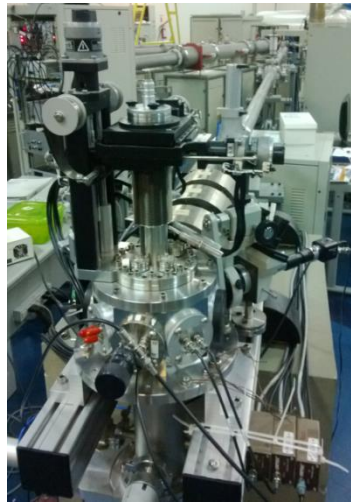
Figura 9: Imagem da câmara de irradiação da linha de microfície de íons, do LII-UFRGS.
