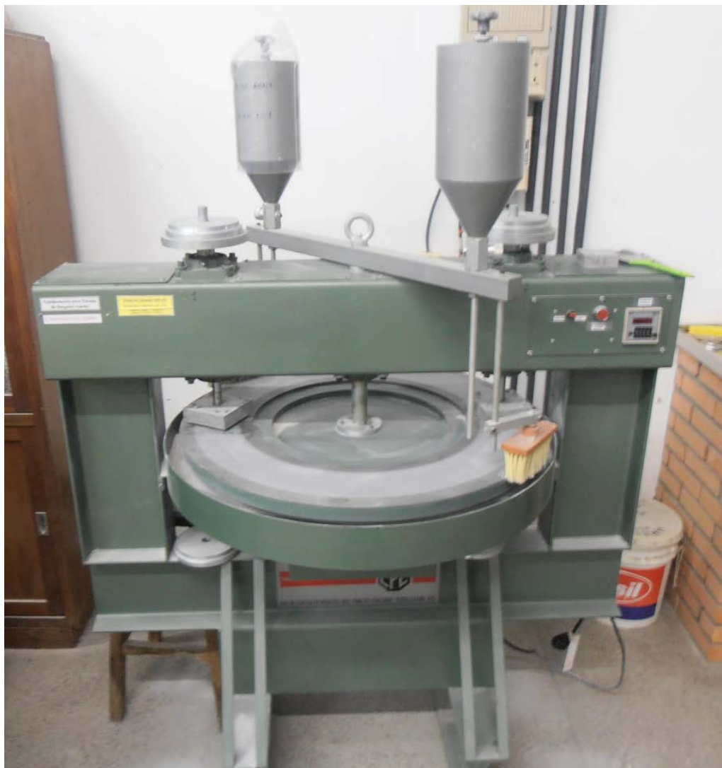
Figura 23 - Equipamento utilizado para realizar desgaste por abrasão amsler. Corpos-de-prova são comprimidos contra chapa de aço rotatória onde é inserida areia a partir dos dois funis superiores. Fonte:Freitas(2015).
