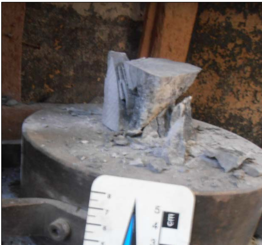
Figura 18 - Corpo-de-prova de dacito após rompimento, em forma de cunha. Fonte: Freitas (2015).
