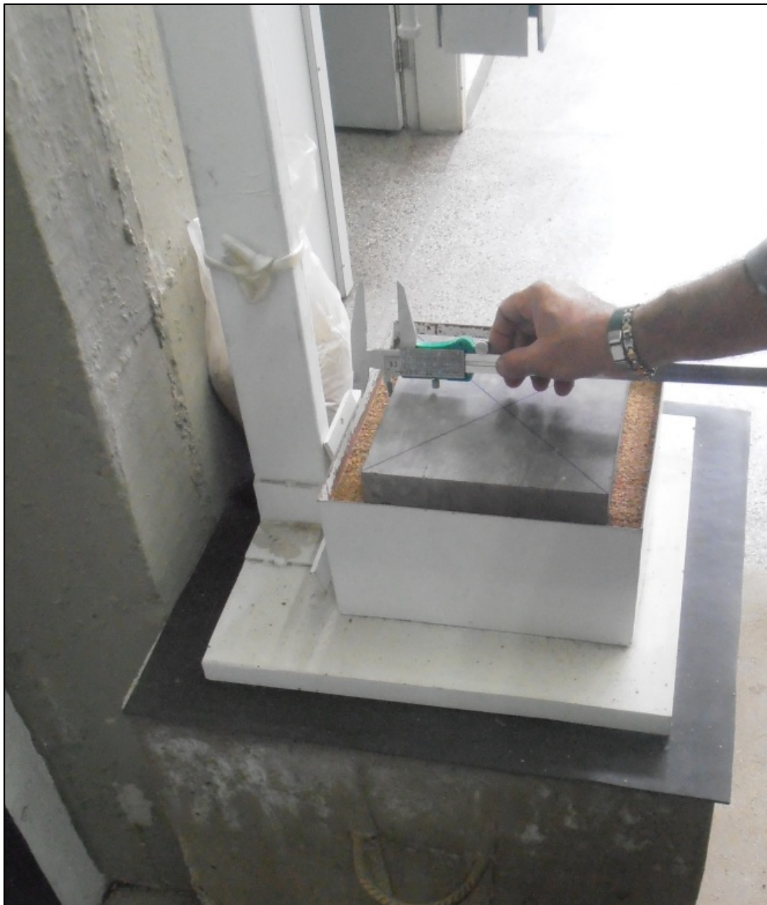
Figura 20 - Funcionário da CIENTEC realizando as medidas para centralizar o corpo-de-prova no colchão de areia.
