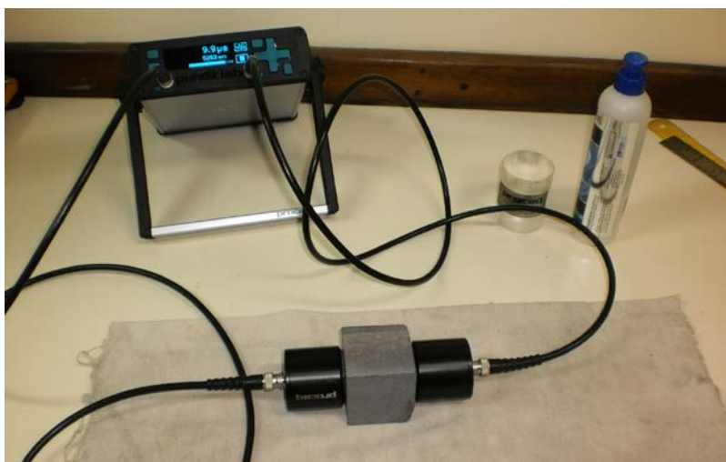
Foto 1 - Ensaio para a determinação da velocidade de propagação da onda P.
