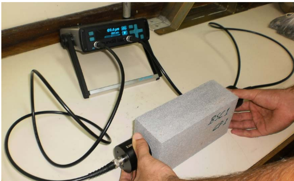
Foto 2 - Ensaio para a determinação da velocidade de propagação da onda P.
