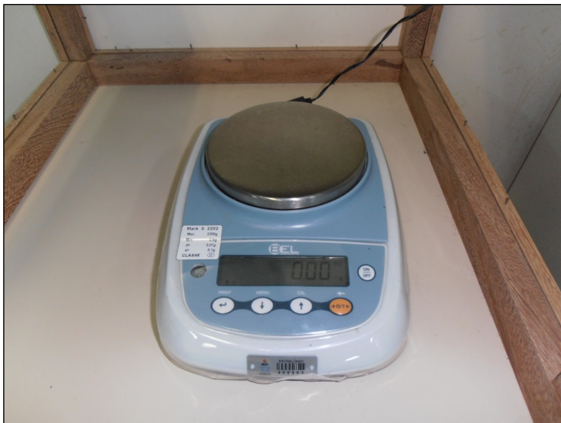
Figura 13 - Balança BEL 2Kg utilizada para pesar os corpos-de-prova. Fonte: Freitas (2015).
