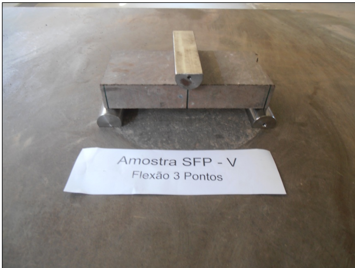
Figura 16 - Amostra de basalto preparado para o ensaio de resistência à flexão em três pontos com os três cutelos.
