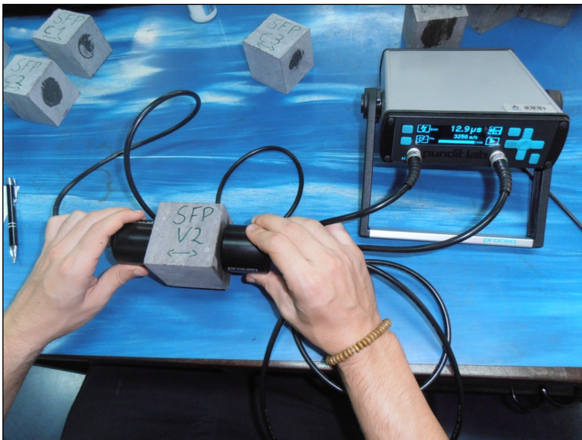
Figura 15 - PUNDIT LAB utilizado para a medição do tempo de propagação da velocidade sônica. Fonte: Freitas (2015).
