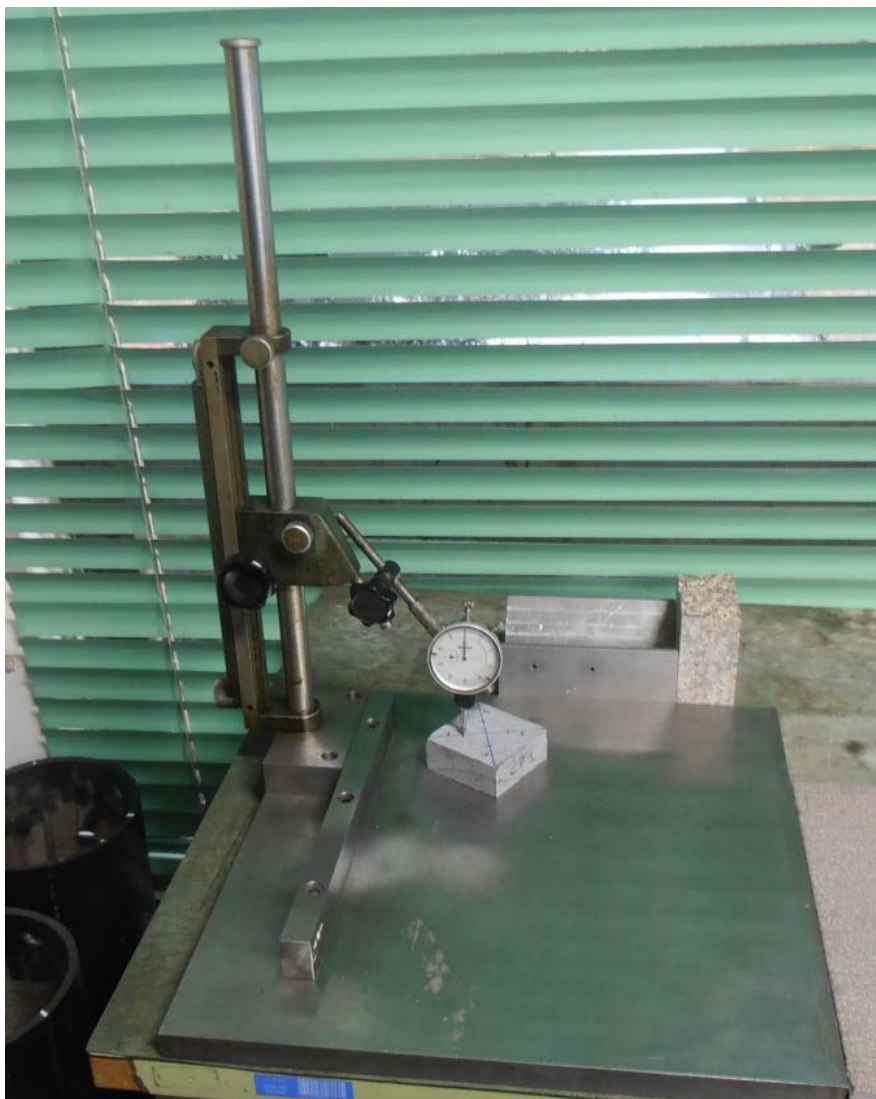
Figura 22 - Relógio comparador com precisão de milésimo de milímetro utilizado para medir desgaste por abrasão amsler dos corpos-de-prova ensaiados. Fonte: Freitas (2015).
