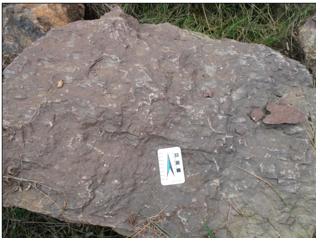
Figura 2 - Face irregular e brilho graxo de rocha basáltica em matacão exposto após detonação para construção de estrada vicinal. Fonte: Freitas (2015).
