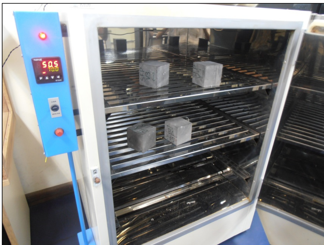
Figura 12 - Estufa pequena modelo S250SD utilizada para secar amostras e medir sua massa seca. Fonte: Freitas (2015).
