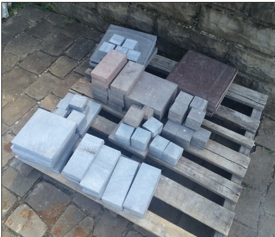
Figura 11 - Chapas polidas e corpos-de-prova. Fonte: Freitas (2015).
