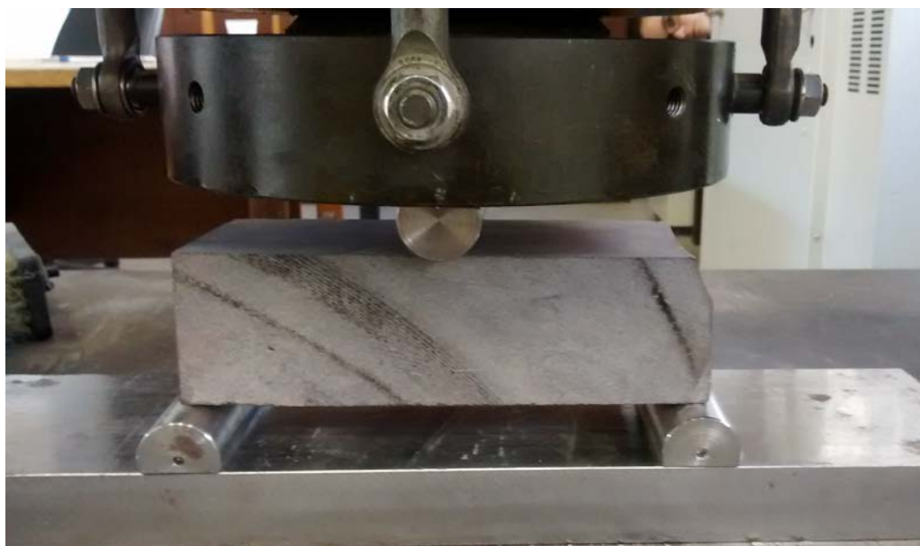
Foto 2 - Detalhe de corpo de prova durante a ruptura à flexão pelo método de três pontos.
