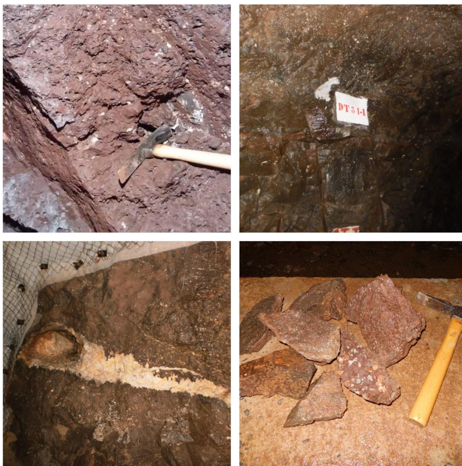
Imagem 7: Basalto vesículo amigdaloidal, túnel superior direito. A foto inferior à esquerda mostra uma das cavidades de basalto vesículo amigdaloidal semi-preenchida por quartzo e zeólita.
