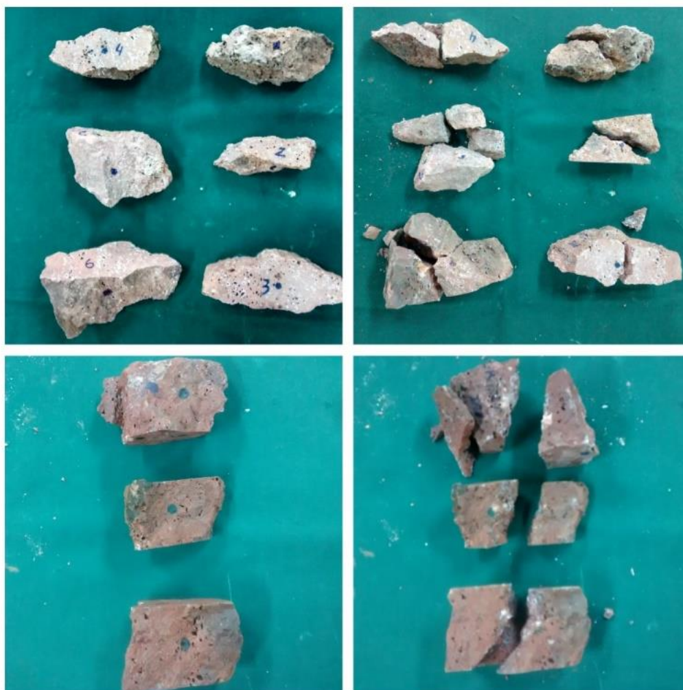
Imagem 11: Brecha basáltica antes do ensaio de carga pontual (esquerda) e após o rompimento (direita).
