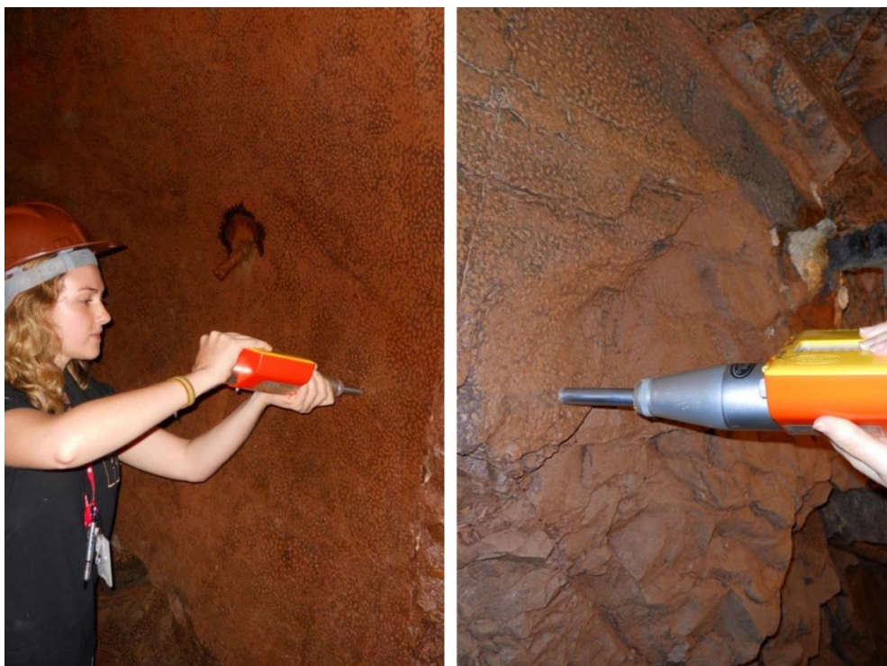
Imagem 4: Utilização do equipamento martelo de schimdt in situ .
