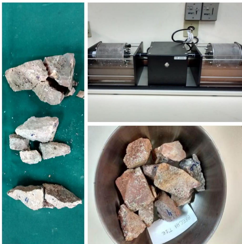
Imagem 5: Seleção de amostras e equipamento utilizado para o ensaio Slake Durability .
