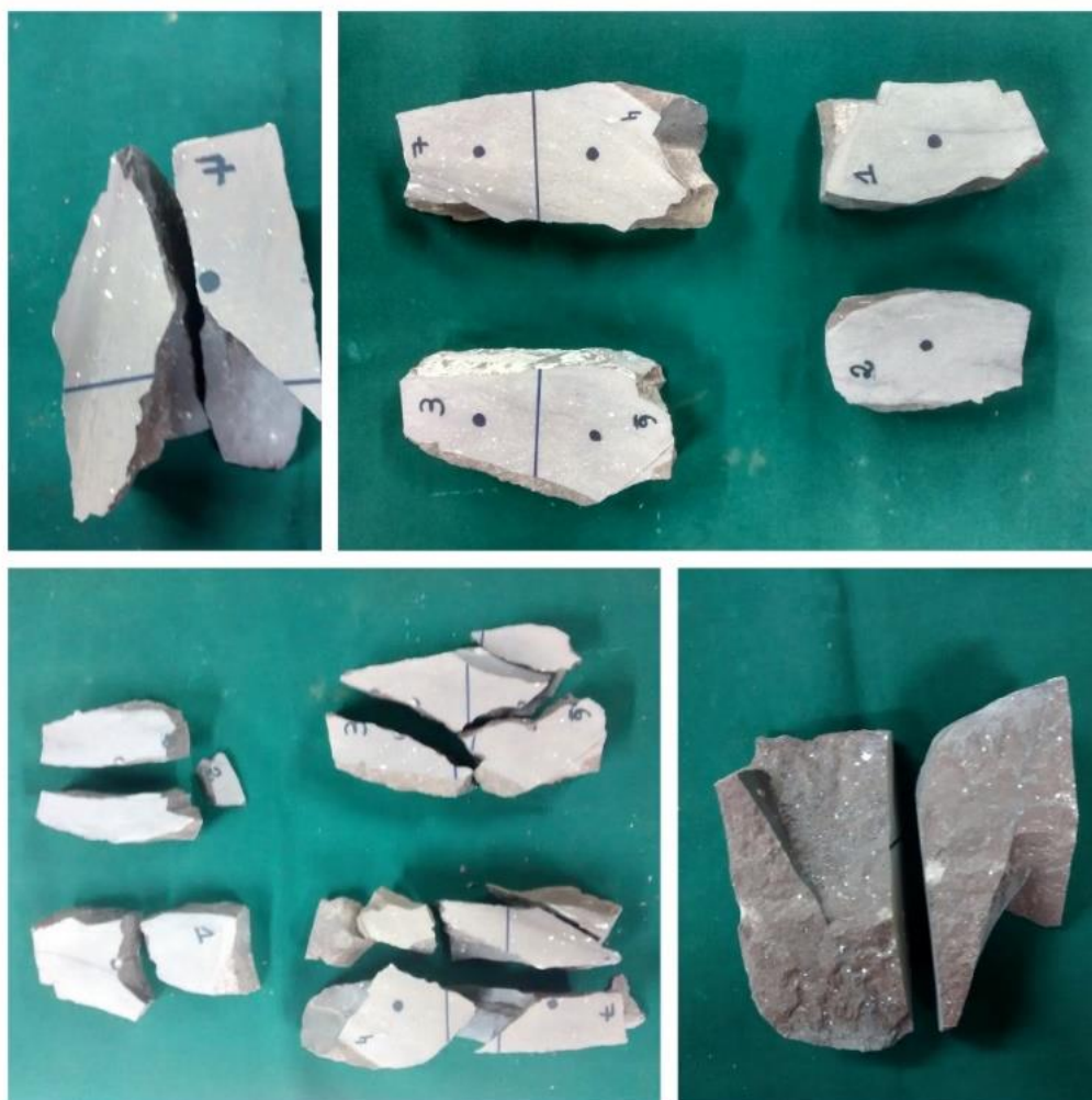
Imagem 10: Basalto compacto antes do ensaio de carga pontual e após o rompimento.
