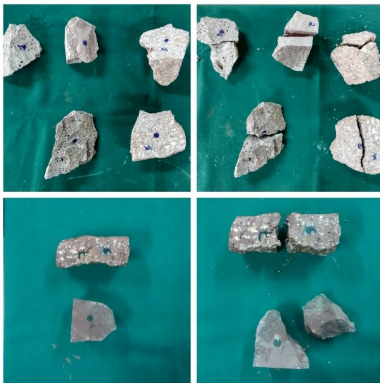
Imagem 12: BVA antes do ensaio de carga pontual (esquerda) e após o rompimento (direita).
