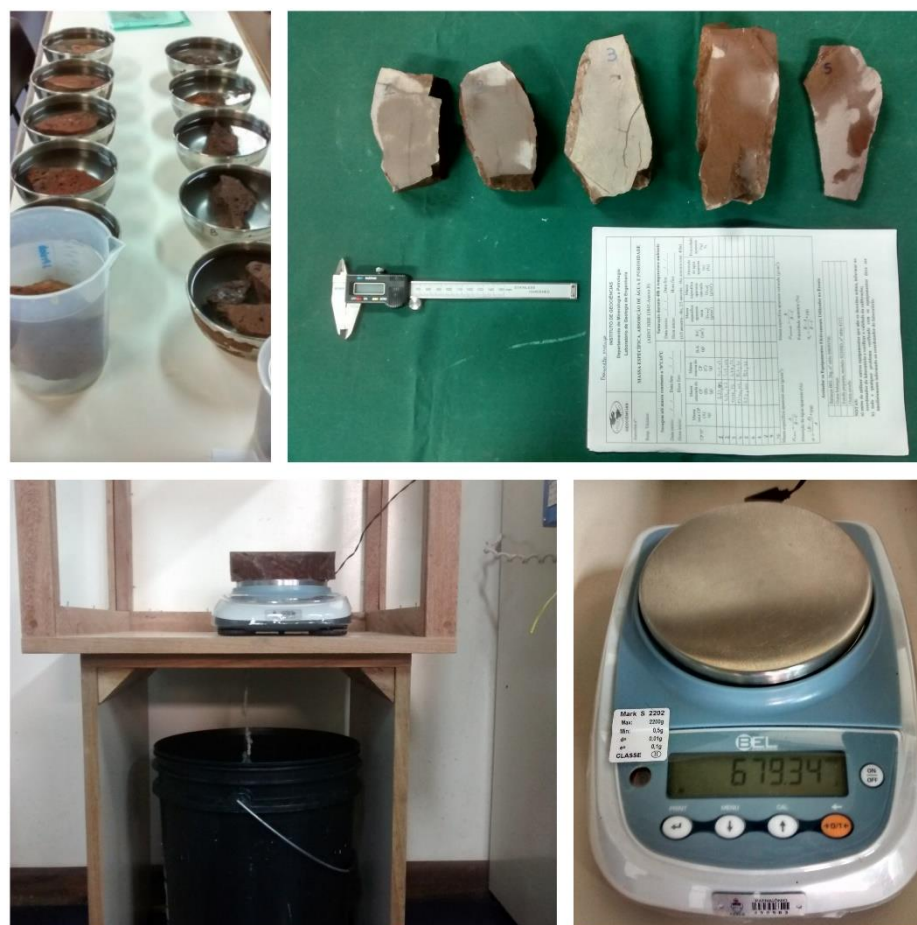
Imagem 1: Procedimento de saturação de amostras para realização do ensaio. Balança com pesagem inferior, recipiente cilíndrico e tanque preenchido com água utilizados no ensaio de determinação de índices físicos.
