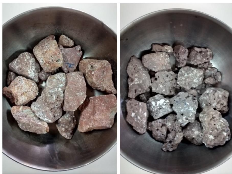
Imagem 13: Brecha (esquerda) e BVA (direita) após o 5º ciclo do slake durability test .
