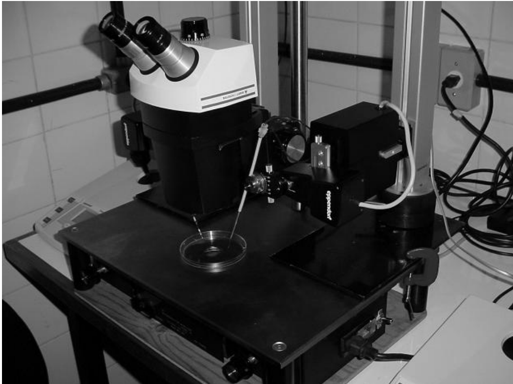
Figura 11. Sistema para a manipulação dos eletrodos de eletrofusão.
