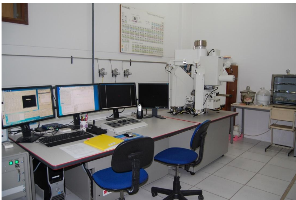
Figura 14. Microsonda Eletônica de varredura (Cameca SXFive) do laboratório de Microsonda da UFRGS, utilizado nas microanálises.
