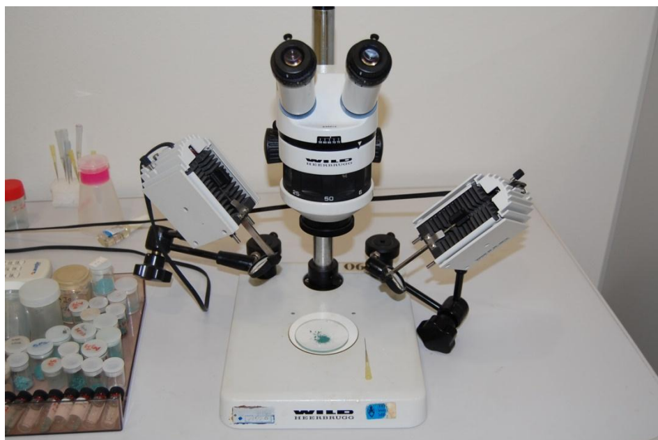
Figura 8. Lupa Estereoscopia do Laboratório de Microsonda eletrônica da UFRGS, utilizada para a purificação dos argilominerais.
