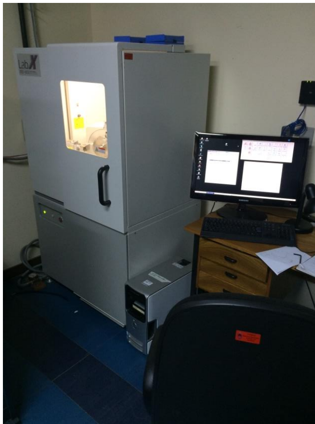
Figura 11. Difratômetro de raios X utilizado para as análises DRX (Foto do autor).
