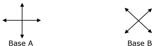
Figura 7. Representação das bases adotadas por Alice e Bob para a transmissão de fótons.
