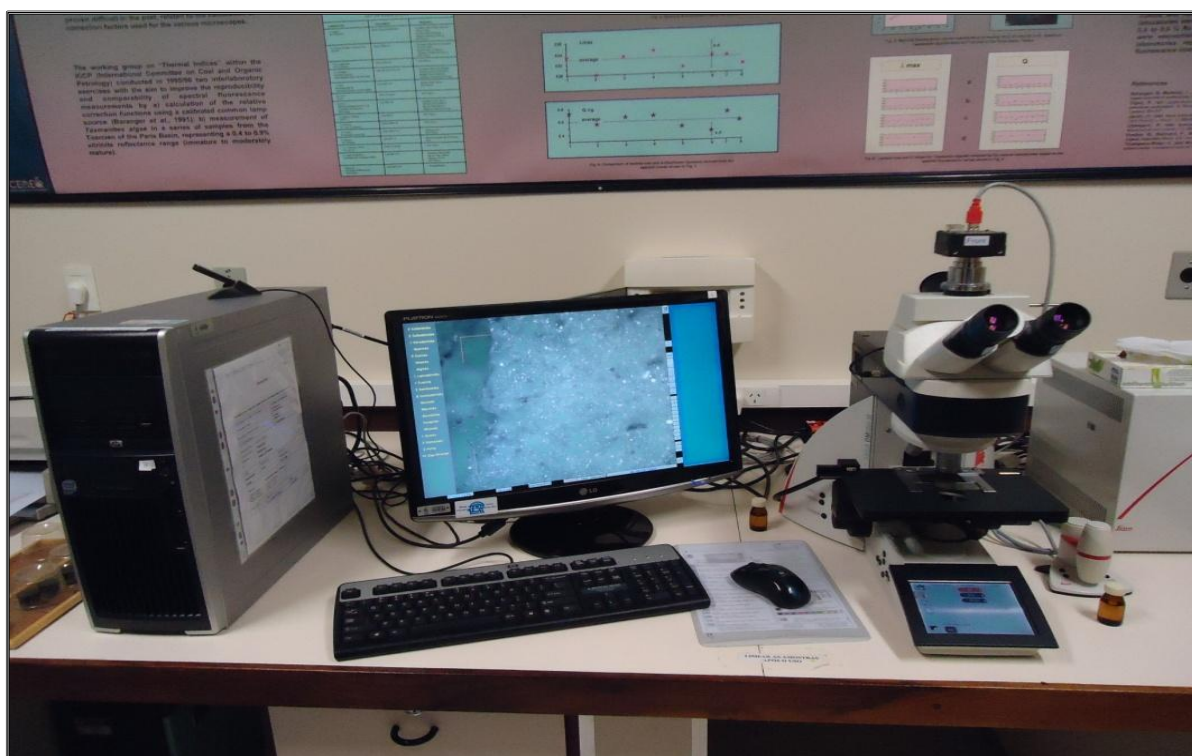
Figura 9. Microscópio Leica DM6000 M utilizado para análise de reflectância da vitrinita.
