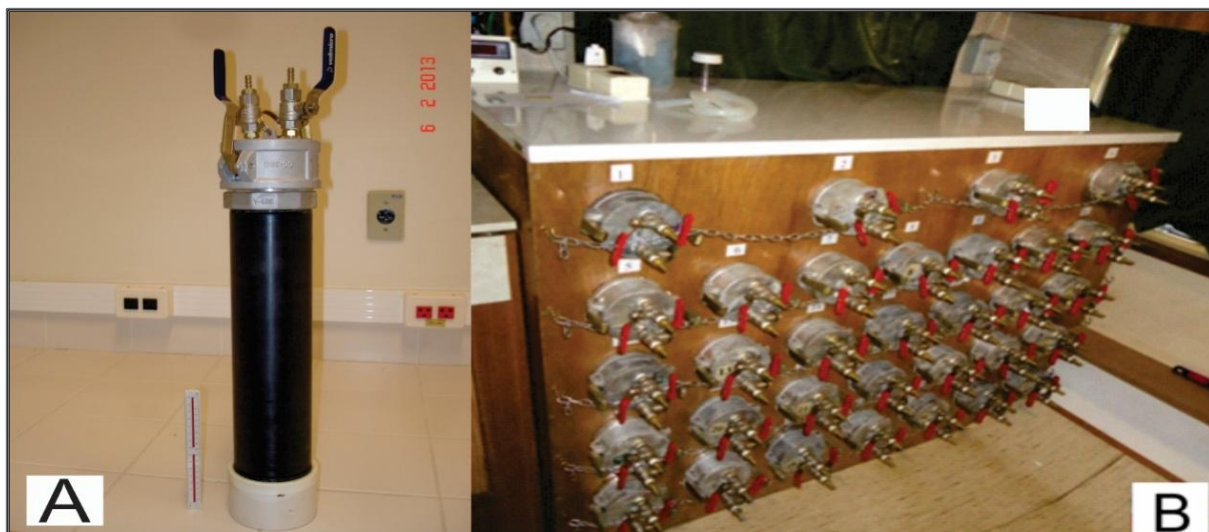
Figura 6. A) Cilindro especial fechado, com 36 centímetros; B) Detalhe da caixa térmica de armazenamento dos cilindros, instalada dentro do laboratório móvel.
