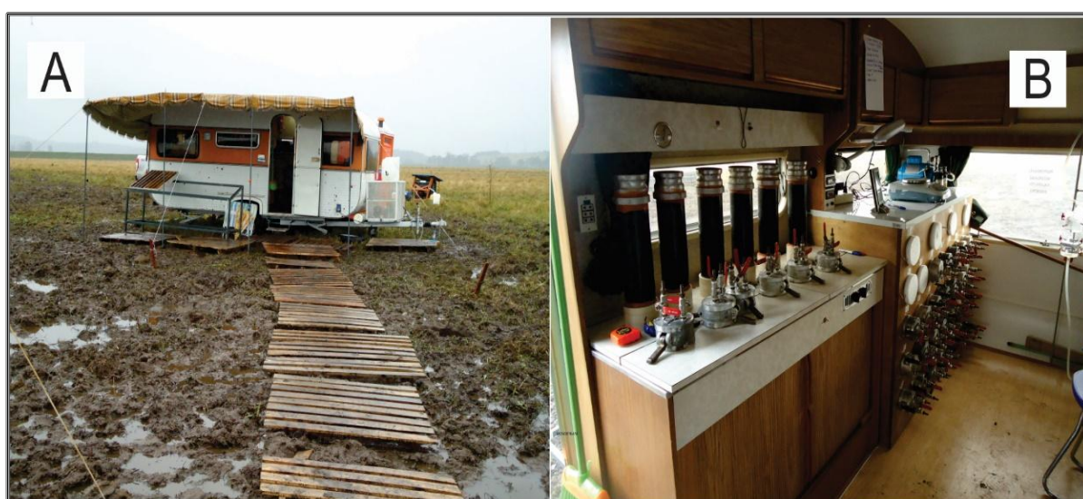
Figura 5. A) Laboratório móvel usado em campo; B) Imagem interna do laboratório, onde está a caixa térmica que mantém os cilindros armazenados, enquanto ocorrem as medidas de dessorção.
