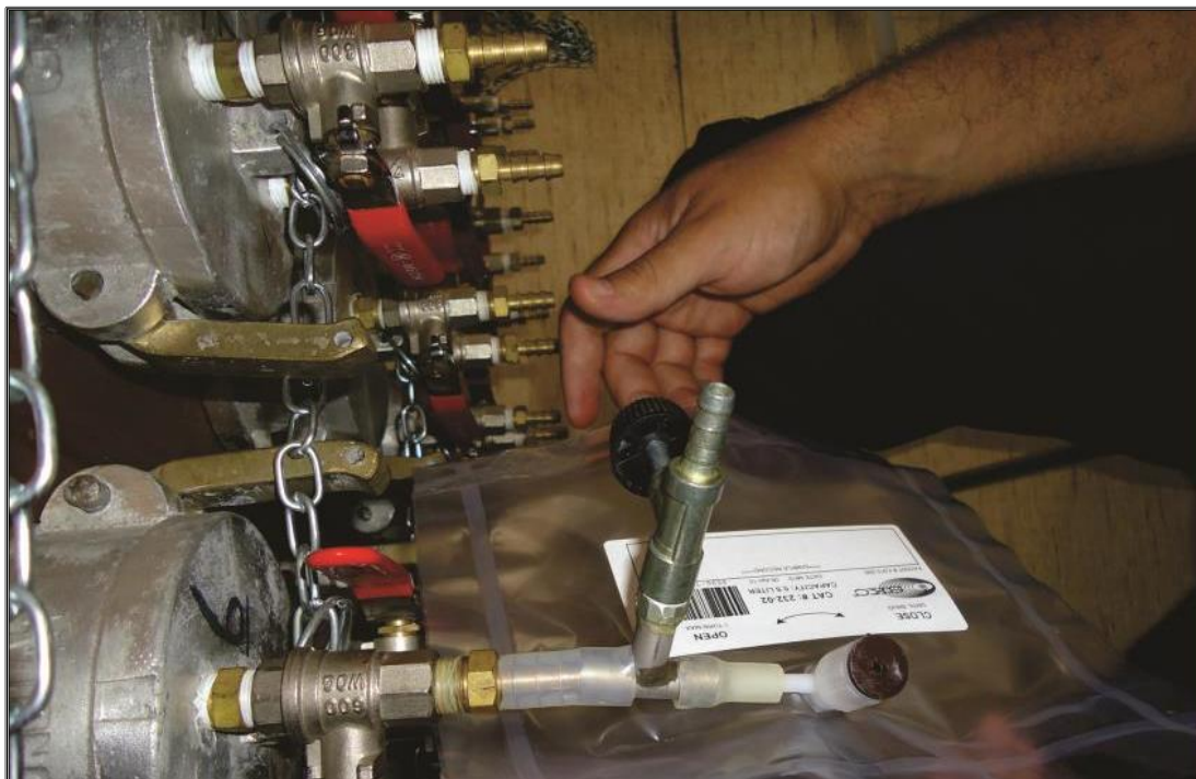
Figura 13. Sample bag (SKC) conectada ao cilindro para a coleta de CBM.
