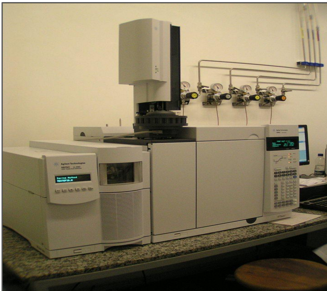
Figura 12. Cromatógrafo gasoso Agilent 7890A (G3440A), com um detector TCD em série com FID.
