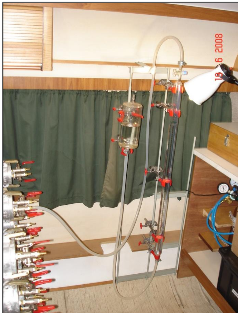
Figura 7. Coluna graduada conectada aos cilindros, e usada na quantificação do volume de gás desorvido de cada cilindro.
