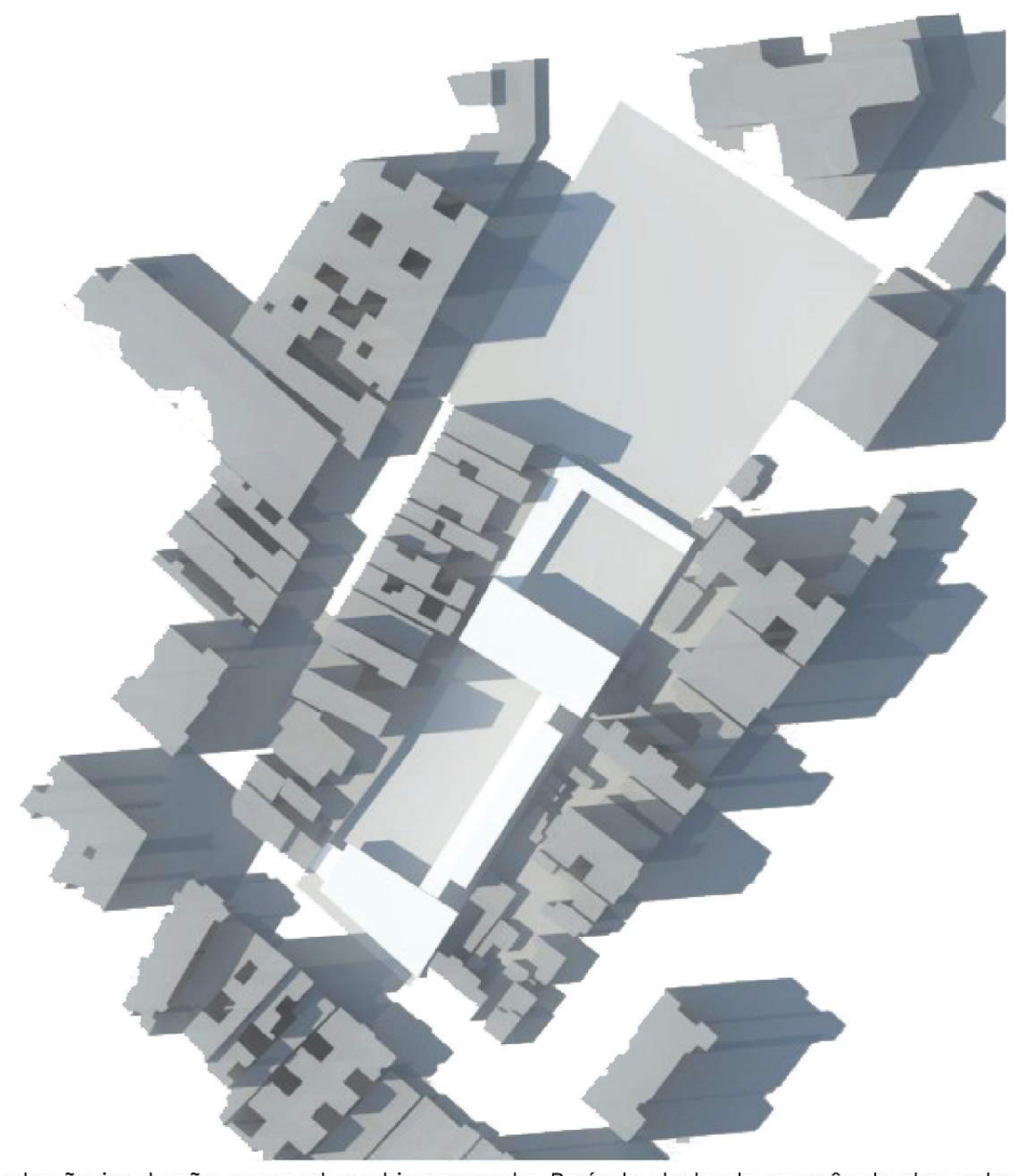
Simulação insolação com volumetria proposta. Período da tarde no mês de dezembro.
