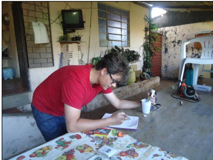
Figura 10 – Análise de pH, TDS e Condutividade com sonda multiparâmetro.
