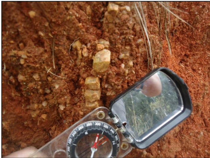
Figura 25 - Solo do manto de alteração do embasamento cristalino de granulometria grosseira.
