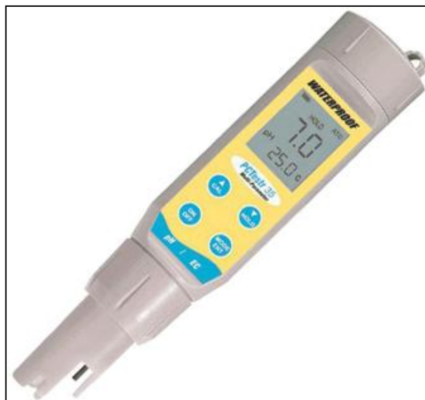
Figura 15 – Sonda multiparâmetro EUTECH, modelo PCTestr 35.
