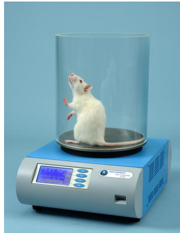
Figura 4. Teste da Placa Quente. Representação da avaliação da sensibilidade térmica (Fonte: Ugo Basile Hot/Cold Plate 35100®).
