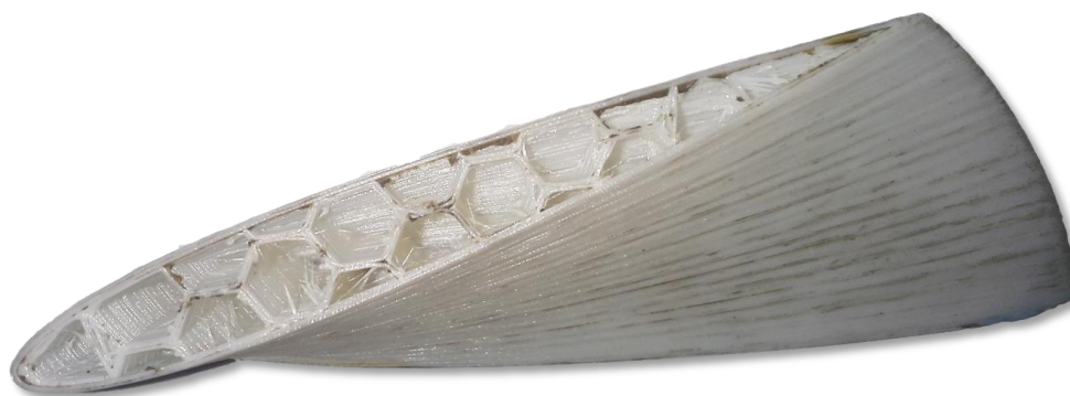
Figura 38 - Estrutura interna apresentada após feito o corte a 50 mm da base da pá
