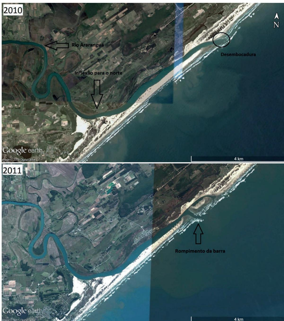
Figura 16: Comparação de imagens de satélite do Google Earth®. A primeira de 2010 mostrando a desembocadura logo a NE da inflexão do canal ao SE. O segundo indicando o rompimento da barra formada, gerando uma nova desembocadura mais ao sul da de 2010.
