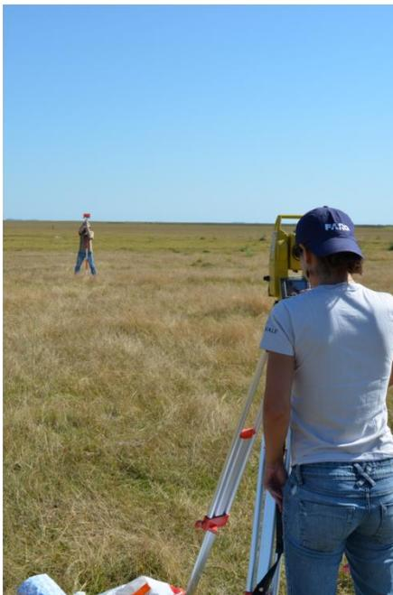
Figura 15. A frente um operador executando o equipamento e ao fundo outro para posicionar o prisma.
