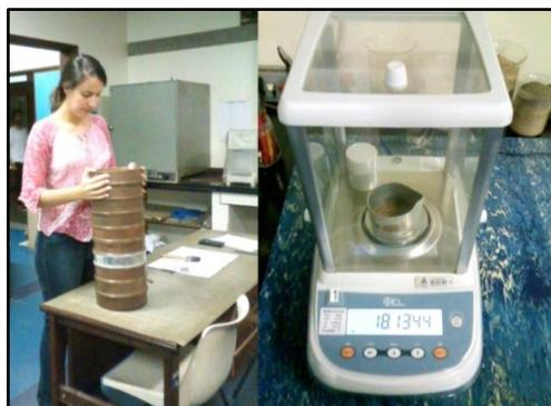
Figura 15 – Processo de peneiramento à esquerda e pesagem dos sedimentos na balança à direita. [Fonte: Dados da Pesquisa, 2015].
