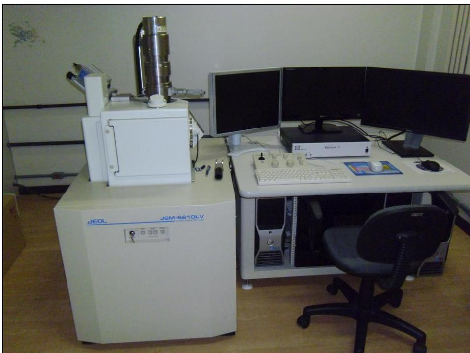
Figura 11 - Microscópio Eletrônico de varredura. Fonte: – MEV/Laboratório de Geologia Isotópica - UFRGS (2015).
