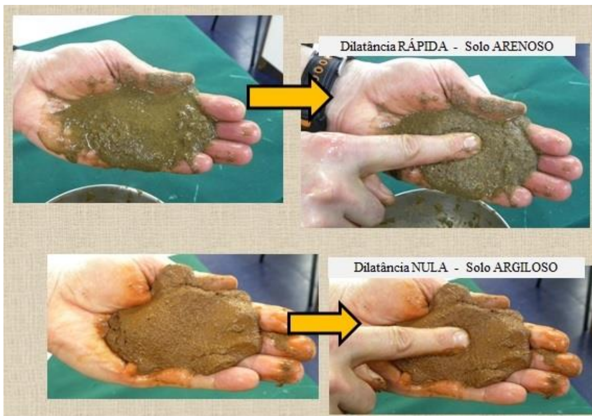
Figura 13 - Teste de Dilatância (Gonzatti, 2013)
