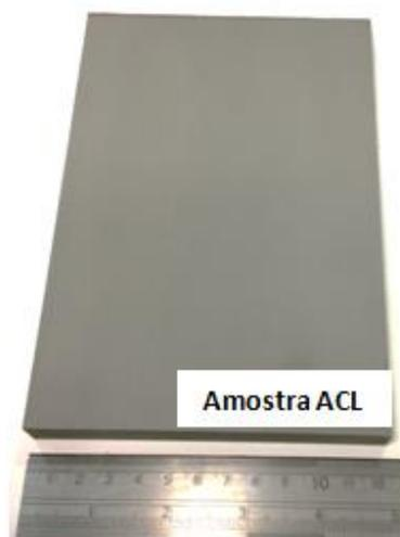
Figura 18 Amostra aspergida e retificada obtida pelo processo HVOGF.
