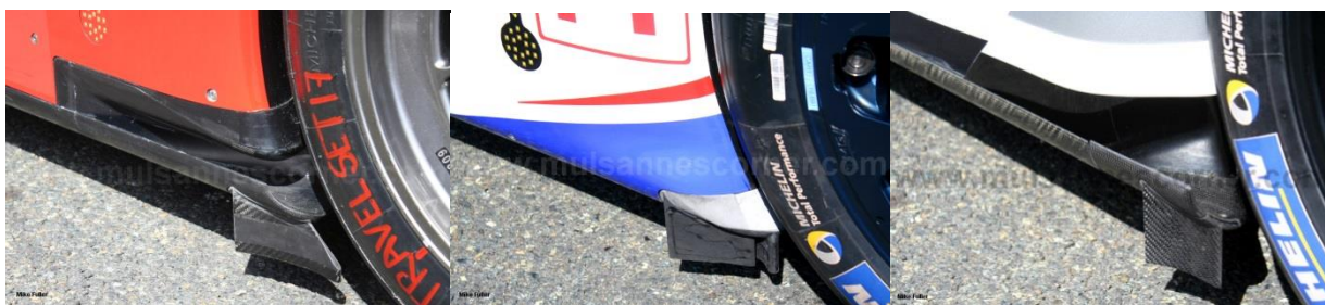
Figura 3.7: Geradores de vórtices de protótipos do campeonato mundial de endurance na etapa das 24 horas de Le Mans. [Mulsannes Corner, 2015]
