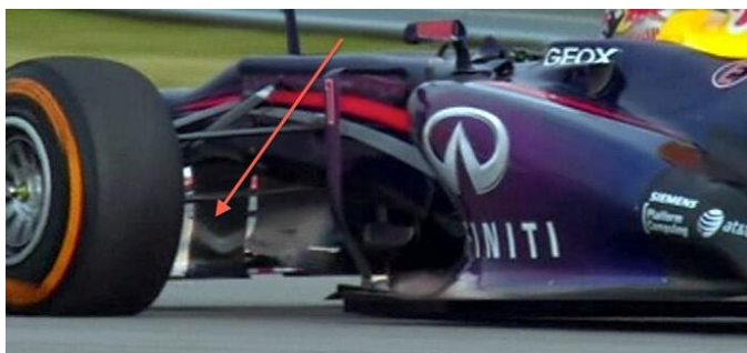
Figura 3.6: Esteira de vórtices visível devido a alta umidade do ar em um veículo de Fórmula 1 durante o GP do Brasil de 2014. [Racecar Engineering, 2015]
