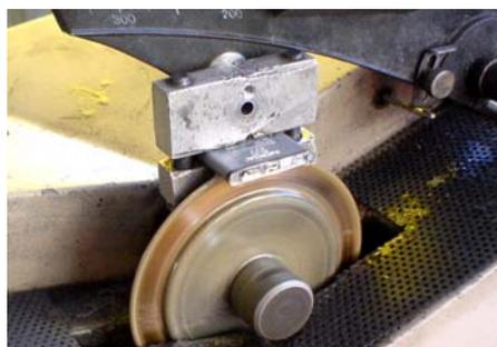
Figura B1 - Bateria Nokia modelo BL-5C sendo cortada para retirada de uma amostra da seção transversal.
