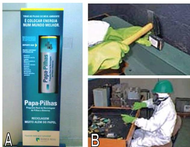
Figura 4 - Pilhas e baterias portáteis usadas pelo Papa-Pilhas (A) são enviadas para a recicladora onde são desmontadas com golpes de martelo (B) sem antes avaliar a capacidade das mesmas para o reuso [34].
