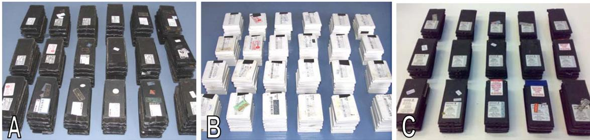
Figura 28 - Baterias NiMH, 3,6V: Nokia modelo BMS-3, 1000 mAh em A, Nokia modelo BMC-3, 900 mAh em B e Ericsson BKB 193 (123-105), 900 mAh em C.
