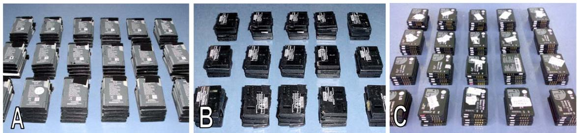
Figura 29 - Baterias Li-Íon, 3,7V: Nokia modelo BL-5C, 850mAh em A e, Siemens modelo V30145-K1310-X250, 700 mAh em B e LGIP-G830, 830 mAh em C.
