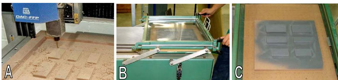
Figura 39 - Fresamento da matriz dos moldes em MDF em A, modelamento da placa de PVC (transparente) com a forma da matriz em B e C.
