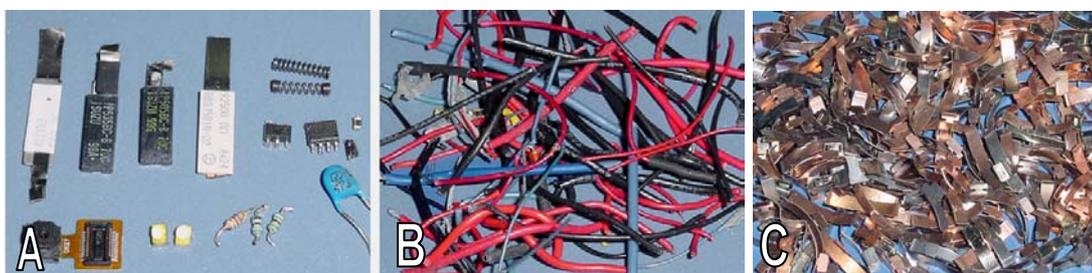
Figura 45 - Componentes diversos presentes nas baterias: termistores, capacitores, transistores, resistências entre outros em A. Cabos presentes em baterias mais antigas em B e componentes metálicos em C.
