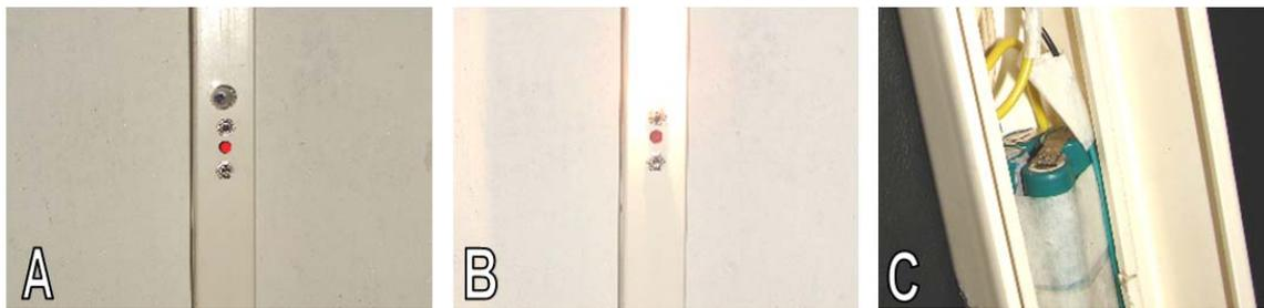
Figura D3 - Protótipo de luz de emergência: desligado em A, ligada em B, e aberto mostrando suas 4 células de NiMH em C.
