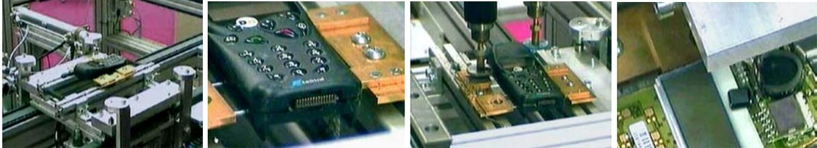
Figura 12 - Dispositivos para desparafusar, cortar o invólucro, remover a tampa e demais elementos de junção dos componentes [63].
