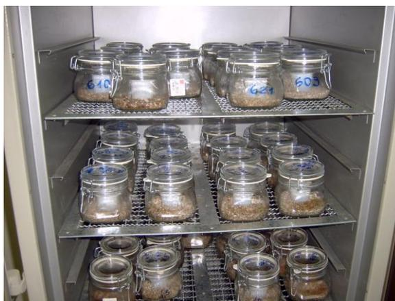
Figura 23: Fotografia das amostras em estufa para ensaio de biodegradação
