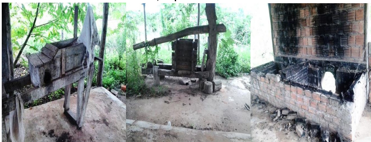
Figura 15 – Farinheira artesanal encontrada na comunidade de Vaquejador Jangada-MT, com instrumentos artesanais feitos para ralar, prensar a mandioca e torrar a farinha, respectivamente
