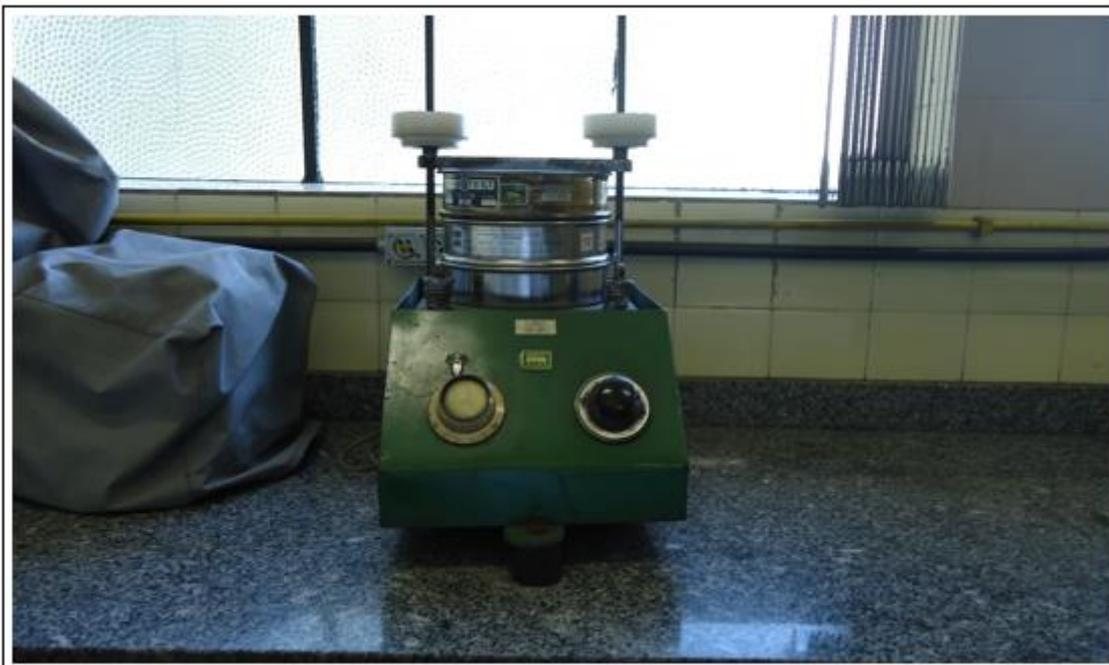
Figura 14: Peneirador utilizado na análise granulométrica das amostras.
