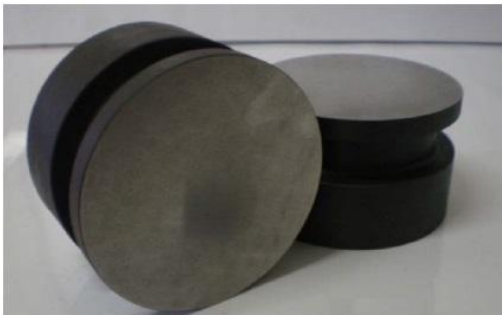
Figura 22: Matrizes para Ensaio de Compressão
