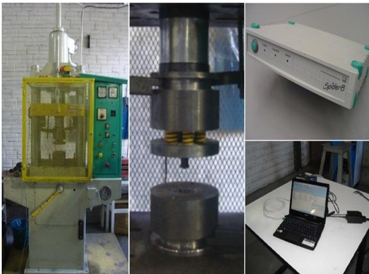
Figura 38: Esquema da Montagem Experimental para Processo de Puncionamento
