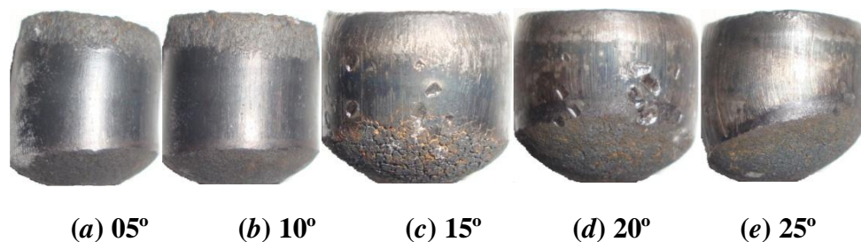
Figura 52: Miolo Expurgado - Zonas de Fratura e Cisalhamento
