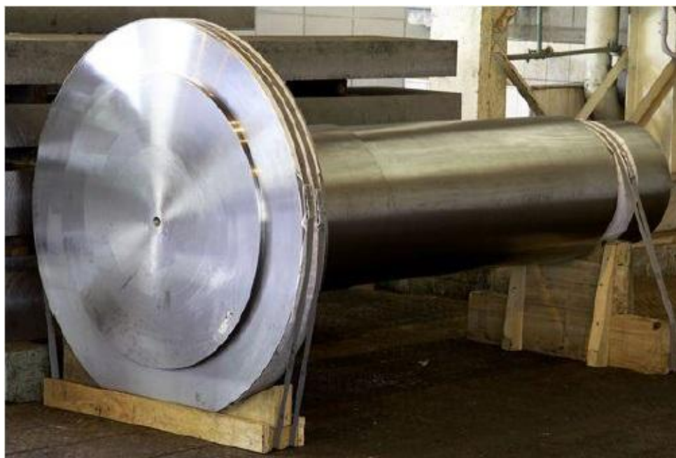
Figura 4: Eixo Maciço Aplicado em Aerogeradores - Cortesia: Villares Metals.
