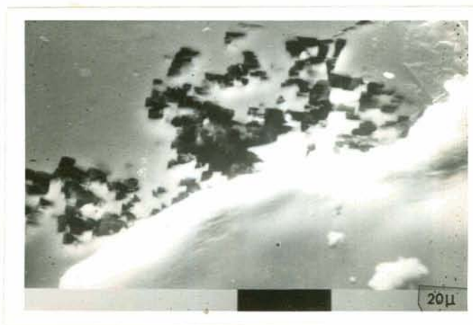
Fig. 15 - Detalhe da presença de corrosão por frestas em alumínio polido, colocado em solução de NaCl 60 p.p.m. 1000 X.
