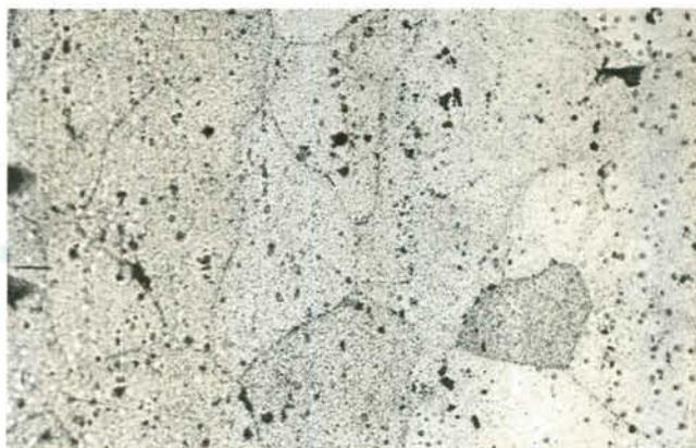
Fig. 8 - Metalografia do alumínio polido atacado em HF 0,5%, mostrando pequenos precipitados escuros. 200 X.
