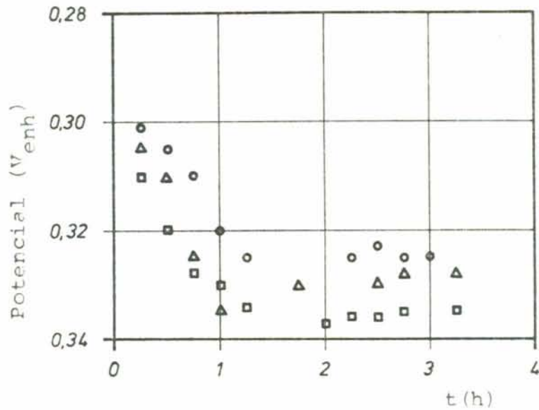
Fig. 43 - Curvas de potencial x tempo para corpos de prova de alumínio polidos acoplados a um cátodo de platina em solução 1 g/l de silicato de sódio neutro + 1060 p.p.m. de NaCl.
