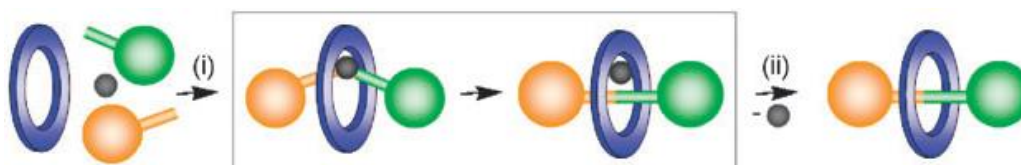
Figura 18. Representação esquemática do método conhecido como metal ativo - estratégia para a síntese de rotaxanos.
