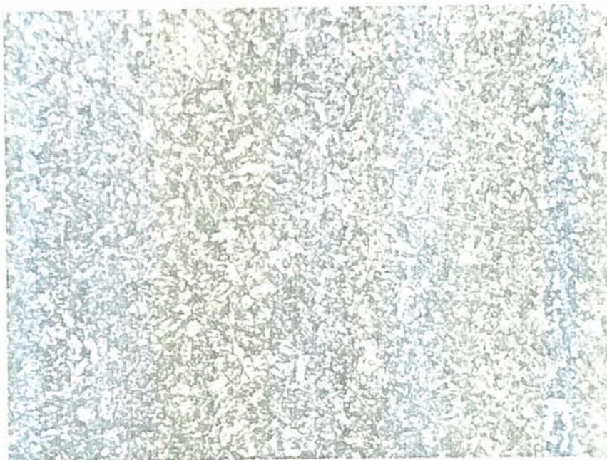
FIGURA 15: Microestrutura do aço "90MnV8" com dureza fina listra 65RC
