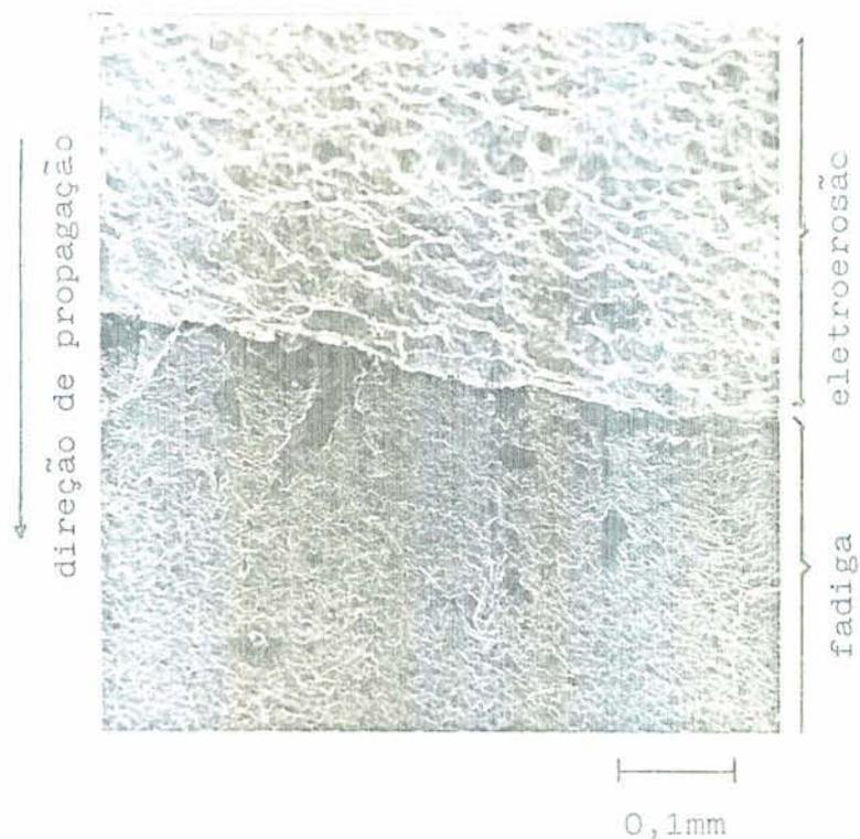
FIGURA 47: Fronteira entre eletroerosão e pré-trinca de fadiga (90MnV8-50RC,  $K_I=15,8\text{MPa}\cdot\text{m}^{1/2}$ )
