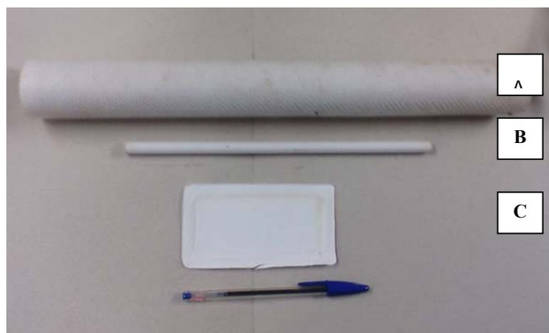
**Figura 3.1:** Fotografias das membranas: espiral (A), tubular(B) e plana (C).
