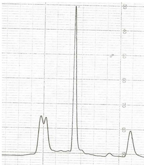
**Figura B.9:** Duplicata da cromatografia gel em coluna de 10 x 300 mm empacotada com a resina Superose™ 12, equilibrada com tampão acetato de sódio 10 mM, pH 4,6; vazão de eluição = 0,5 mL.min<sup>-1</sup>, amostras monitoradas pela absorbância a 280 nm.
