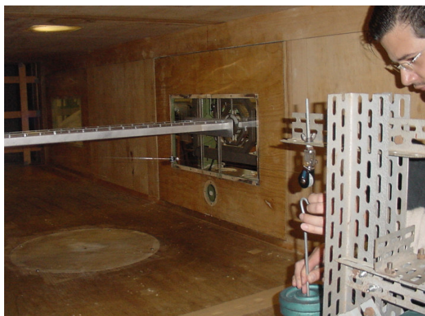
Figura 17: detalhe da calibragem da célula de carga
