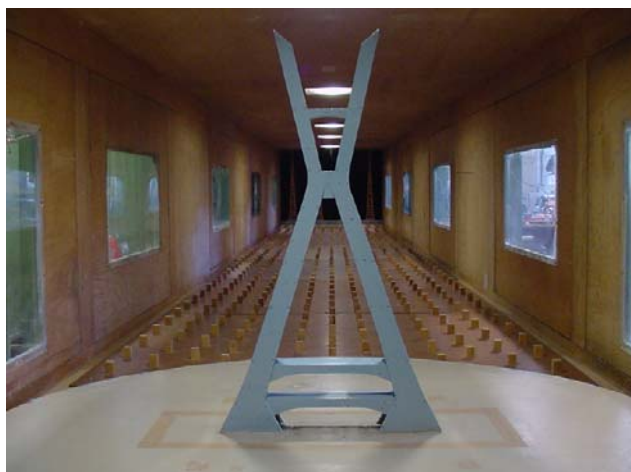
Figura 16: modelo rígido do mastro no túnel de vento para medir pressões
