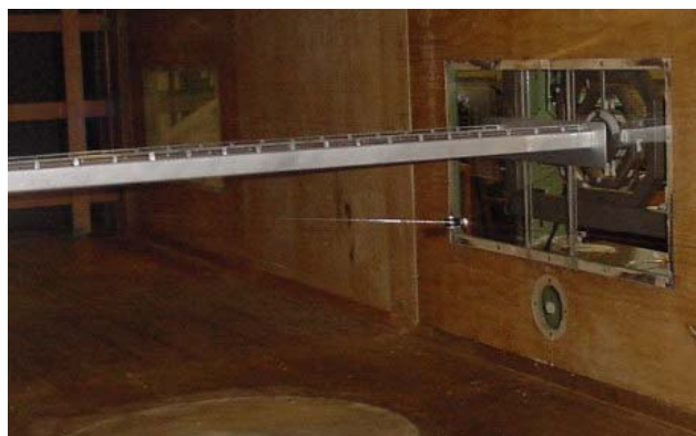
Figura 72: modelo seccional de forças com célula de carga
