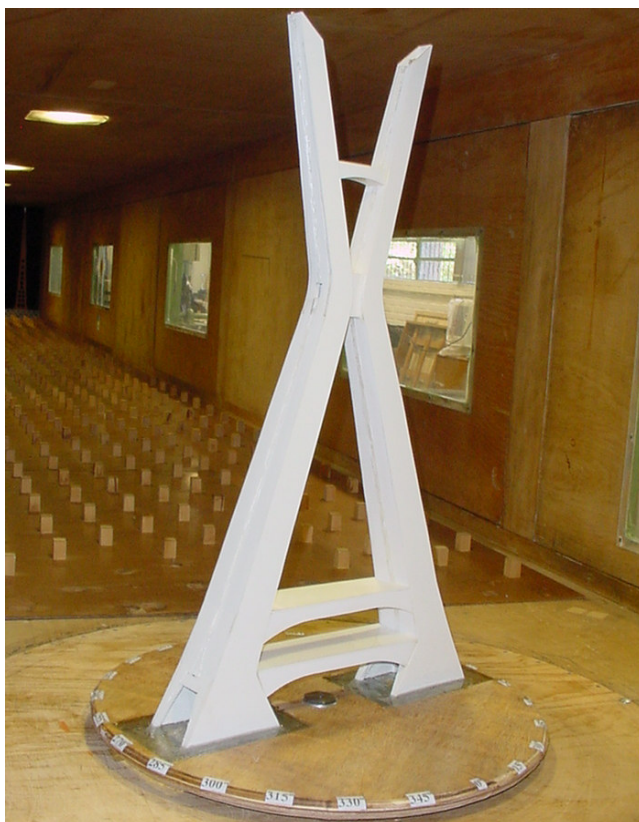
Figura15: modelo rígido do mastro para medir forças com célula de carga
