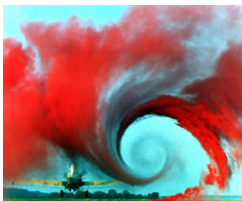
Figura 26: vórtice criado na passagem da asa do avião revelado pela fumaça (site da NASA)
