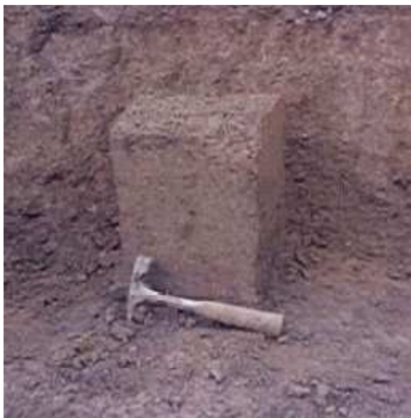
Figura 67: bloco talhado manualmente
