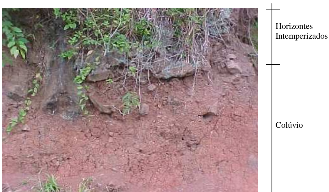
Figura 66: perfil de Podzólico Vermelho-Amarelo, em colúvio de arenito (próximo ao km 998 do Gasoduto)
