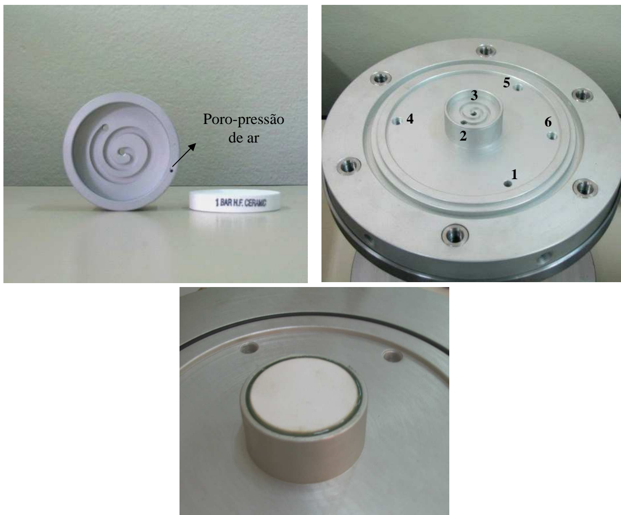
Figura 33: cabeçote e pedestal com ranhura em espiral e disco cerâmico de AVEA
