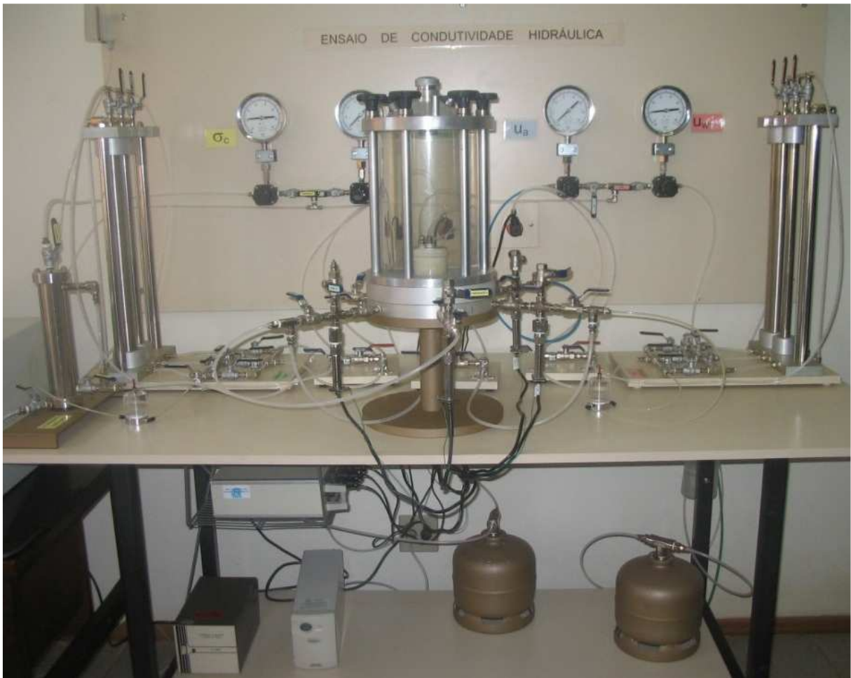
Figura 45: permeômetro triaxial para ensaio de condutividade hidráulica não saturada
