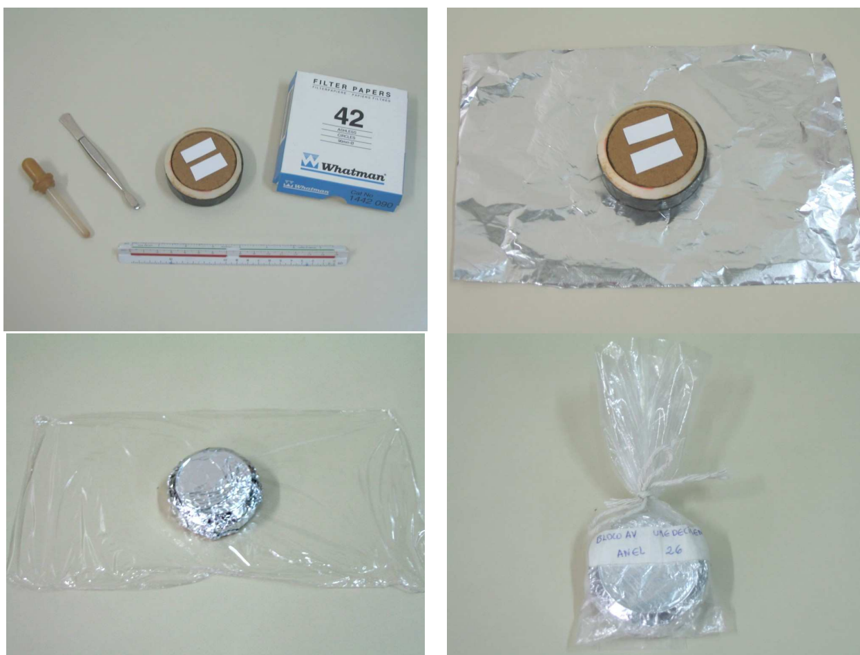
Figura 74: método do papel filtro utilizado nesta tese
