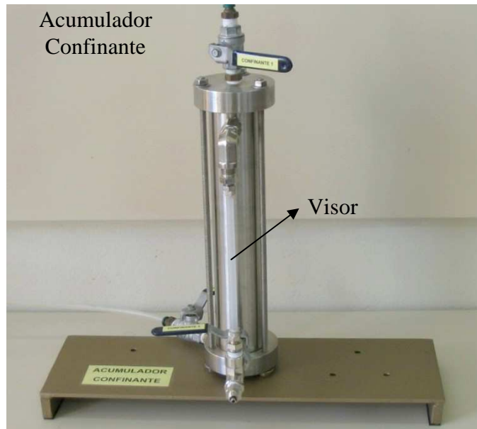
Figura 36: acumulador para aplicação da tensão confinante
