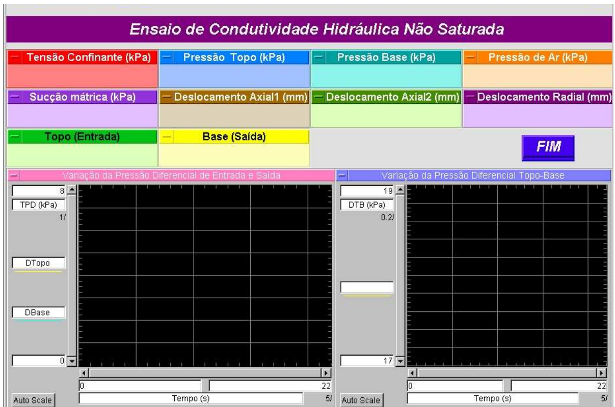
Figura 51: ensaio de condutividade hidráulica não saturada
