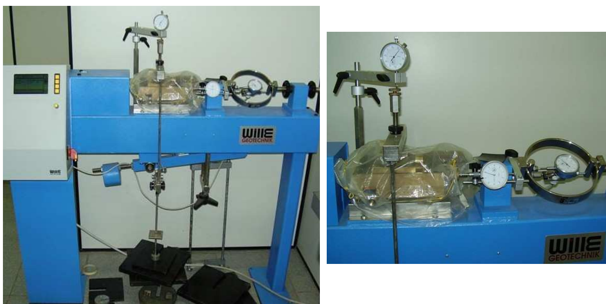
Figura 77: equipamento de cisalhamento direto convencional (amostras secas ao ar)
