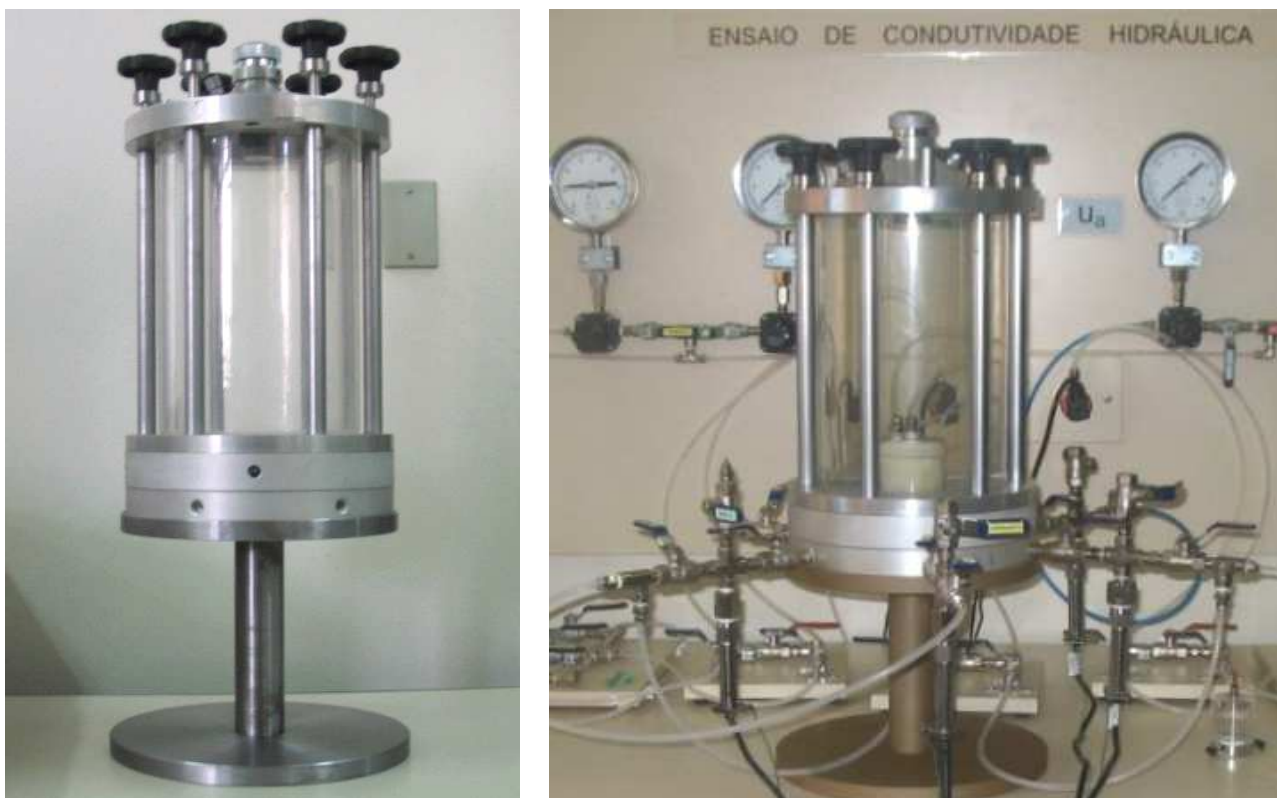
Figura 34: célula triaxial sobre o suporte, antes e após instalação dos transdutores de pressão
