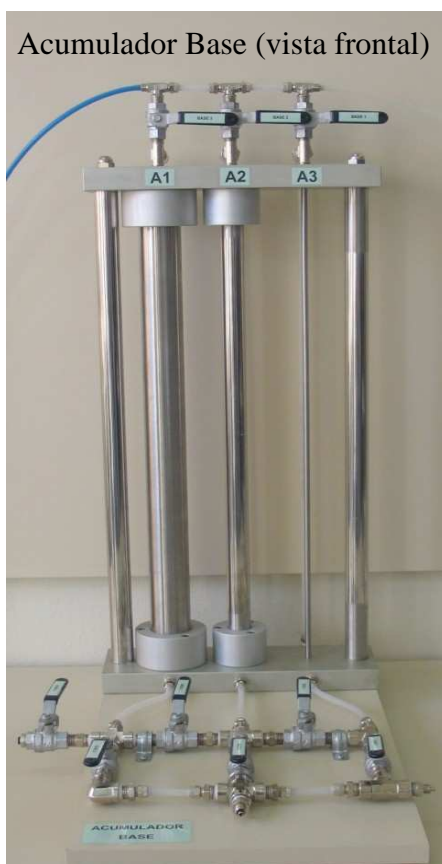
Figura 37: acumulador para aplicação da tensão na base e/ou no topo
