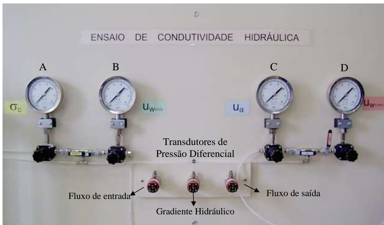
Figura 35: painel de controle com reguladores de pressão
