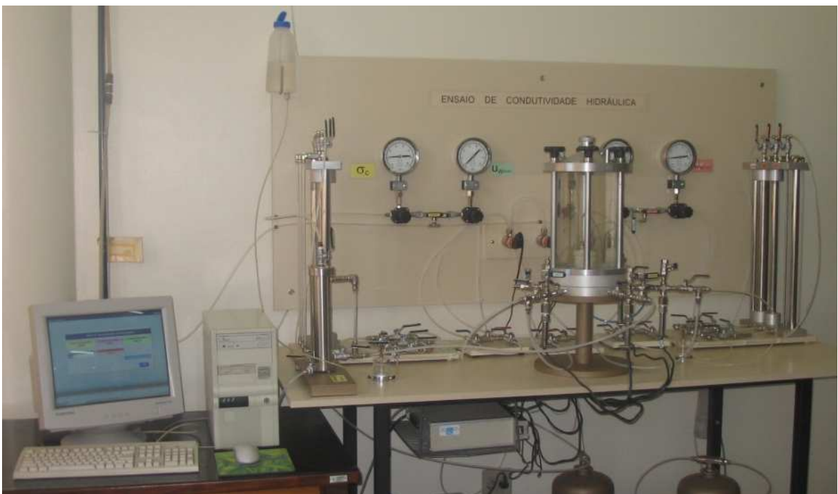
Figura 46: permeômetro triaxial e programa de controle
