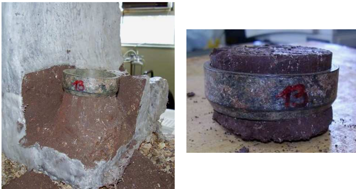
Figura 70: moldagem de corpo de prova indeformado do Solo RO (ensaios de curva característica e cisalhamento direto)
