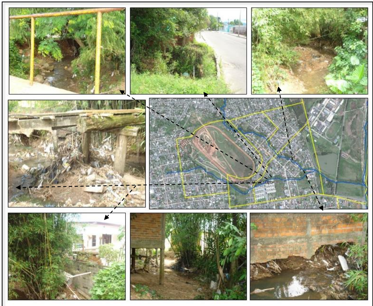
Figura 57: Características da ocupação e situações de ameaça nos Setores Censitários 431690705130003 e 431690705130010. Verifica-se que as intervenções nas margens acontecem de acordo com a situação de cada morador; o assoreamento do canal pelo intenso de lixo aumenta as possibilidades de inundações.
