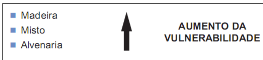
Figura 34: Exemplo de parâmetro observado na pré-setorização do mapeamento. No esquema verifica-se como o material da construção influencia para a vulnerabilidade da moradia frente aos riscos. Fonte: Ministério das Cidades/IPT (2007).
