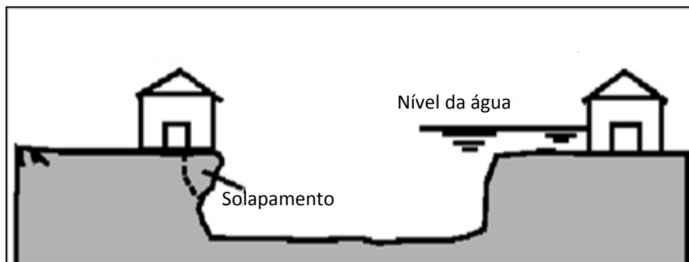
Figura 27: Ação das águas fluviais em moradias situadas junto ao leito do rio. Além das inundações, as moradias podem ser afetadas pelo solapamento das margens. Fonte: Tucci (2003).
