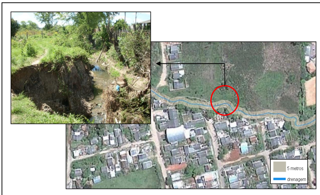
Figura 48: Área suscetível à erosão fluvial no perímetro urbano. Fonte: DigitalGlobe datadas de 11/09/2014, obtidas via Google Earth Pro e trabalhos de campo.
