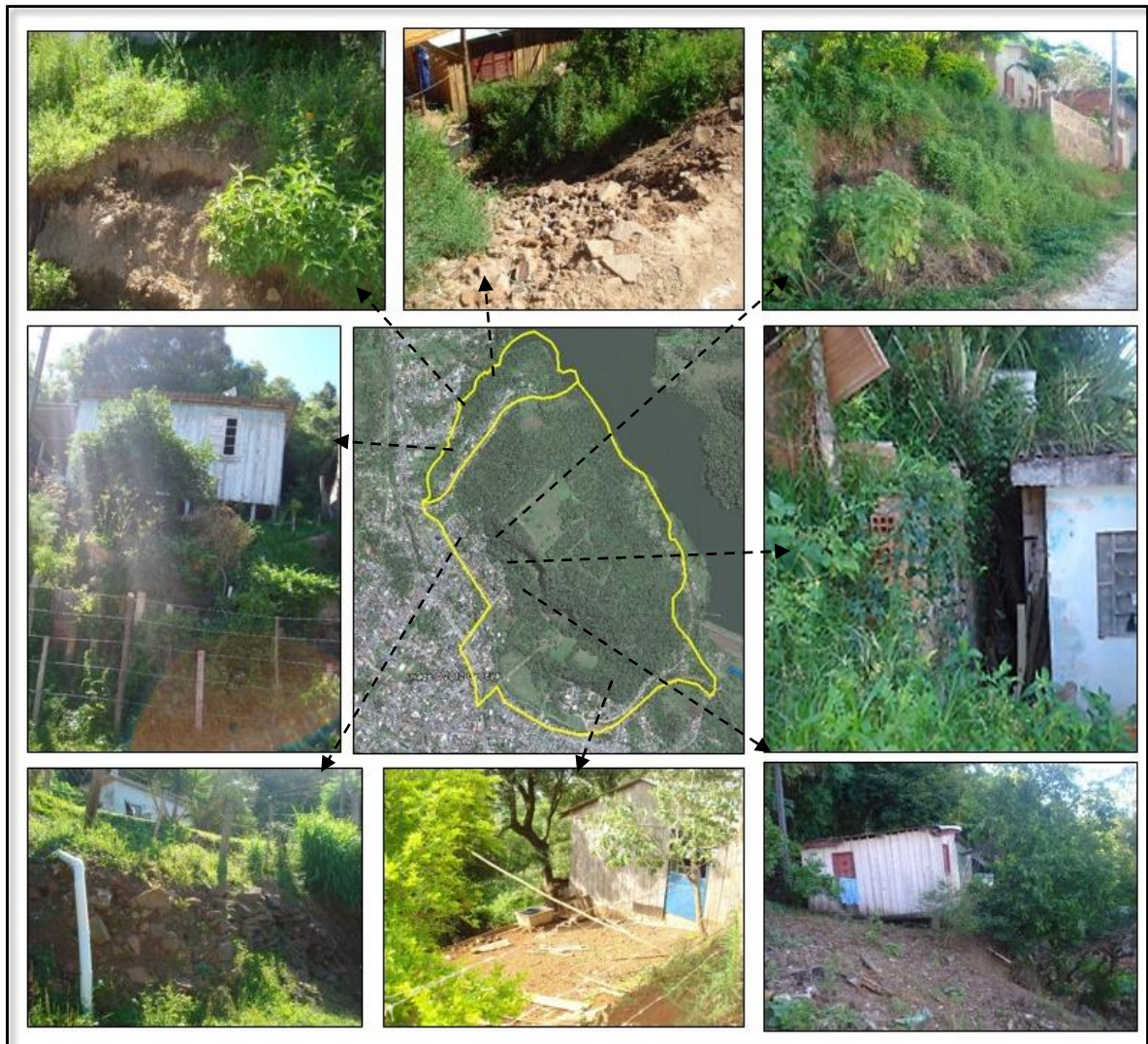
Figura 74: Ocupação e situações de ameaça junto aos Setores Censitários 431690705080021, 431690705080035, região administrativa Nordeste. Verifica-se os diferentes modos de interferência junto às encostas, e o padrão construtivo precário das moradias. Fonte trabalhos de campo, novembro de 2014.
